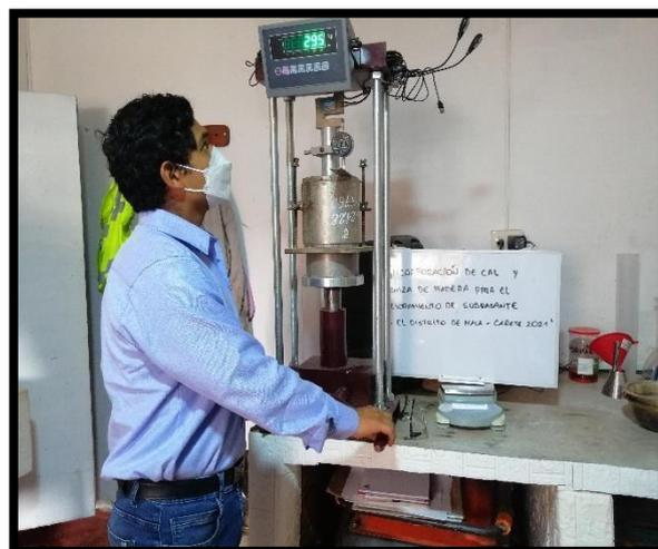
*Figura 24: Prueba de penetración.*
