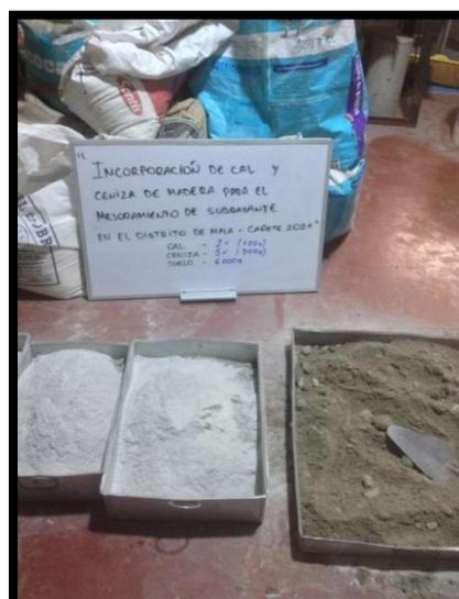
*Figura 17:* Mezcla del SN + 2% CAL + 5% DE CDM.
