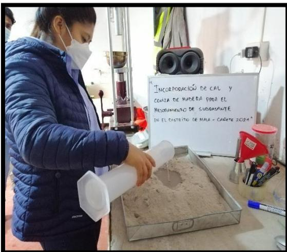
*Figura 19:* Humedad de compactación. adicionando 4.8% de agua.
