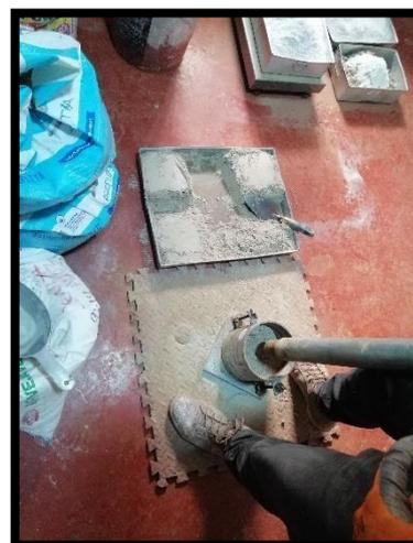
*Figura 20:* Compactación del material SN + 2% cal + 5% CDM.
