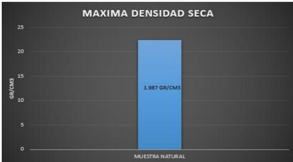
Figura 14: Gráfico de Máxima Densidad Seca de la muestra inicial. Fuente:
