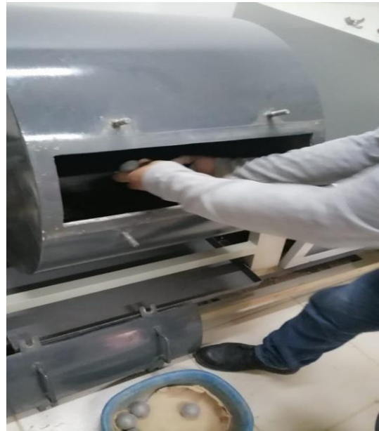
Figura 24. Introduciendo los balines en la máquina Los Ángeles
