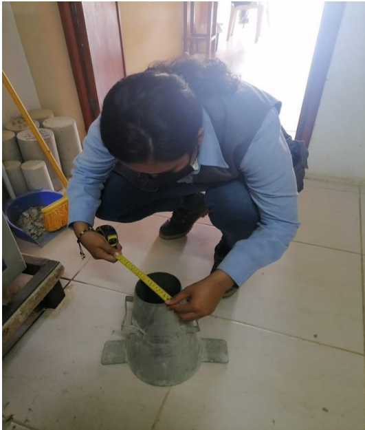
Figura 26. Verificando el cono de Abrams
