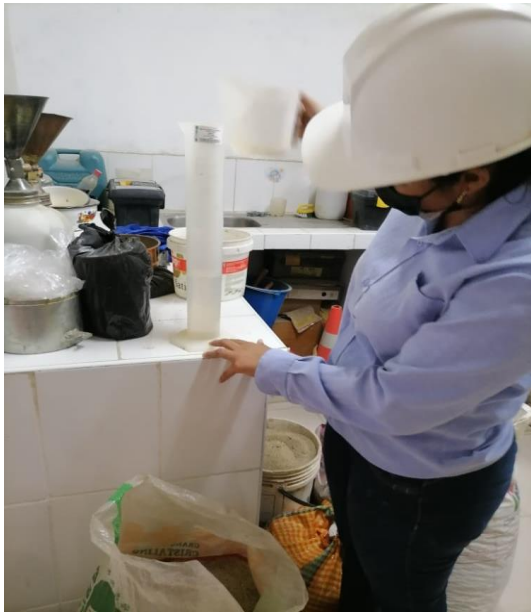
Figura 17. Agregando agua para la decantación
