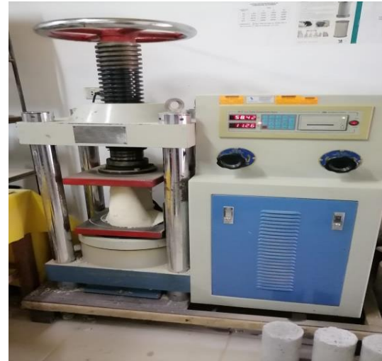
Figura 45. Equipo de ensayo a rotura por compresión
