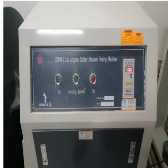
Figura 43. panel de control del equipo Los Ángeles
