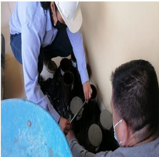
Figura 38. Rasando el concreto en las cubetas
