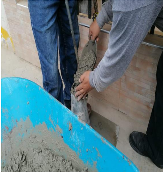
Figura 29. Llenado del cono de Abrams Figura 30. Midiendo el asentamiento
