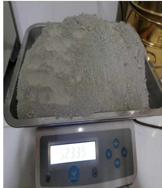
Figura 27. Pesando cemento para medir el asentamiento
