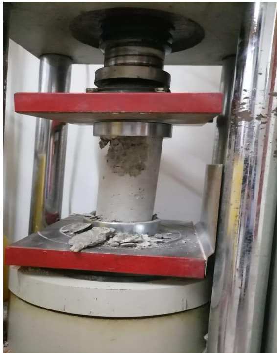
Figura 41. Ensayo de resistencia a la compresión
