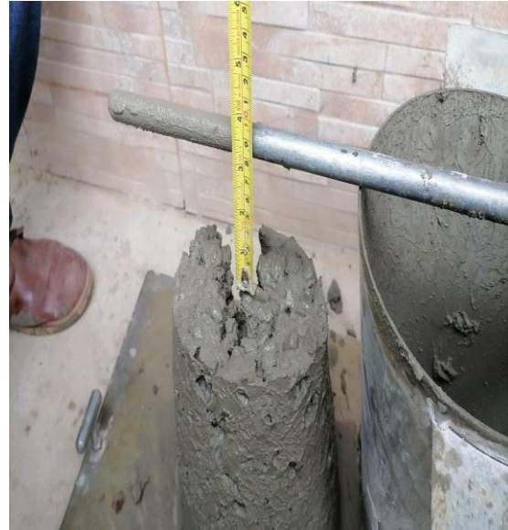
Figura 29. Llenado del cono de Abrams Figura 30. Midiendo el asentamiento
