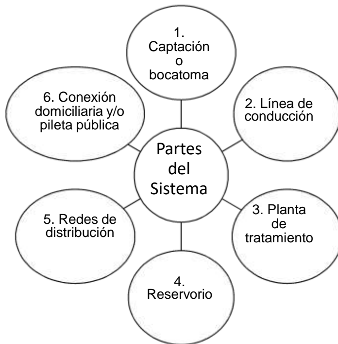
Ilustración 1 Partes del Sistema por Gravedad con Tratamiento
