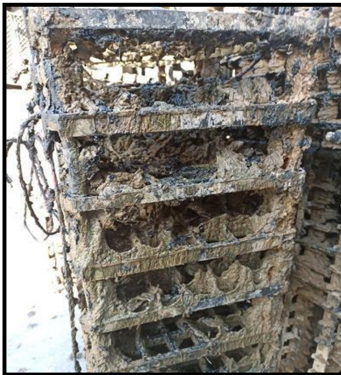
Relleno de propileno con adherencias
