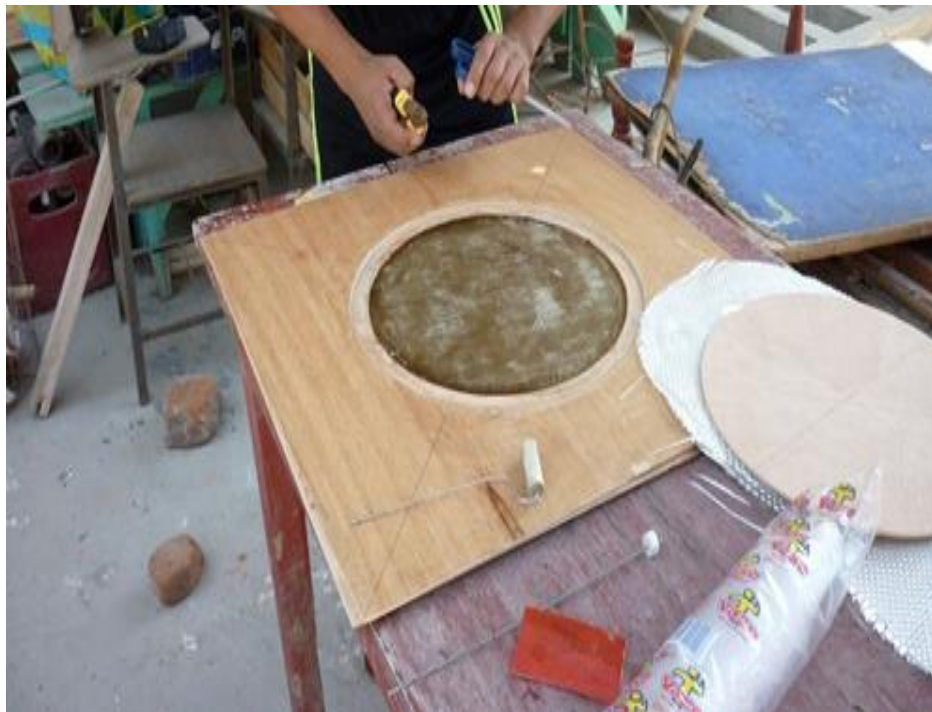
Figura 26: separando el monde después de catalizado de la resina.
