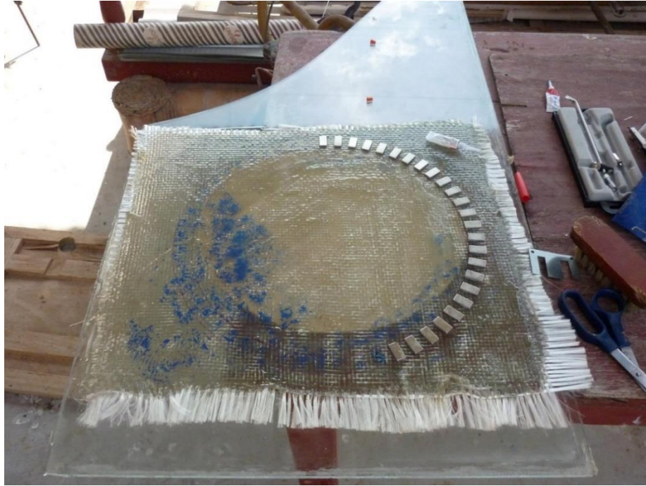
Figura 25: Extendiendo la fibra de vidrio tipo roving con los imanes neodimio
