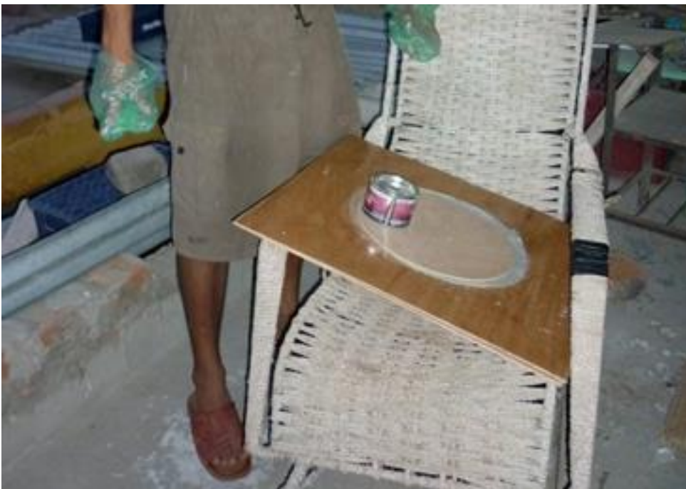
Figura 24: Midiendo la fibra de vidrio en el molde de madera.
