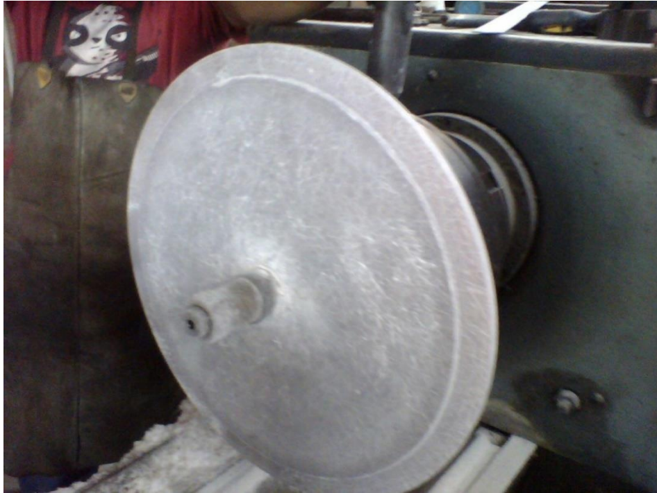
Figura 31: Mecanizando nivel externo.
