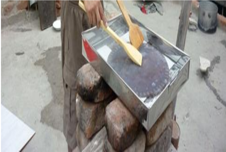
Figura 27: Proceso de lavado en agua desionizada tibia.
