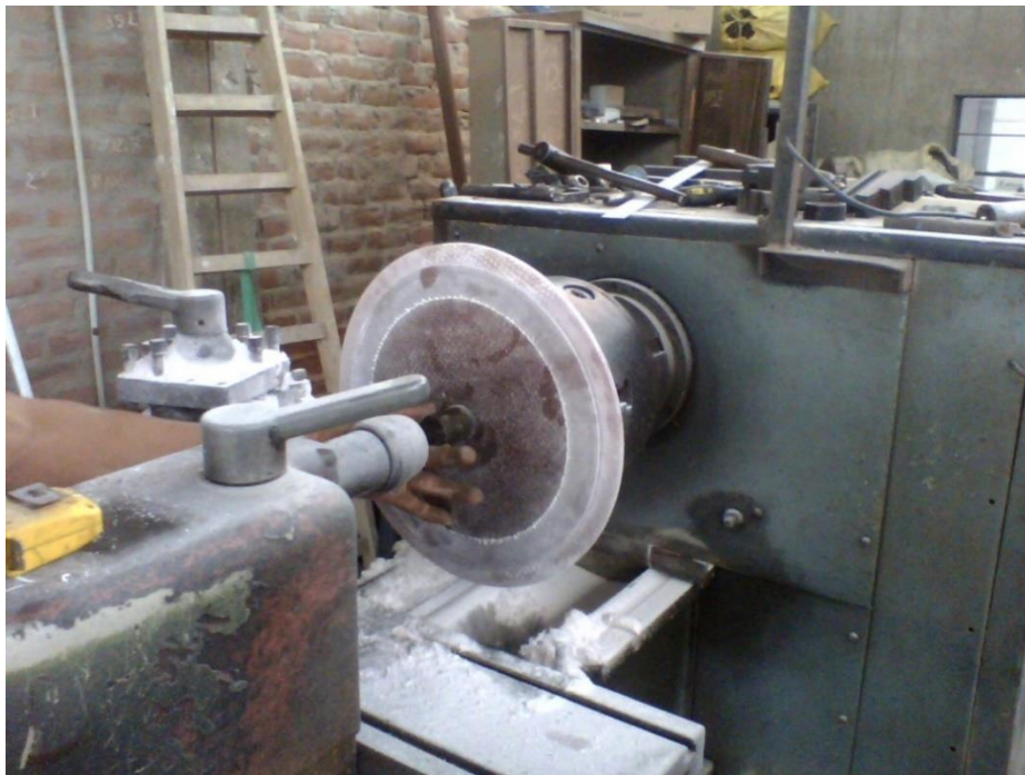
Figura 30: Mecanizando diámetro externo.
