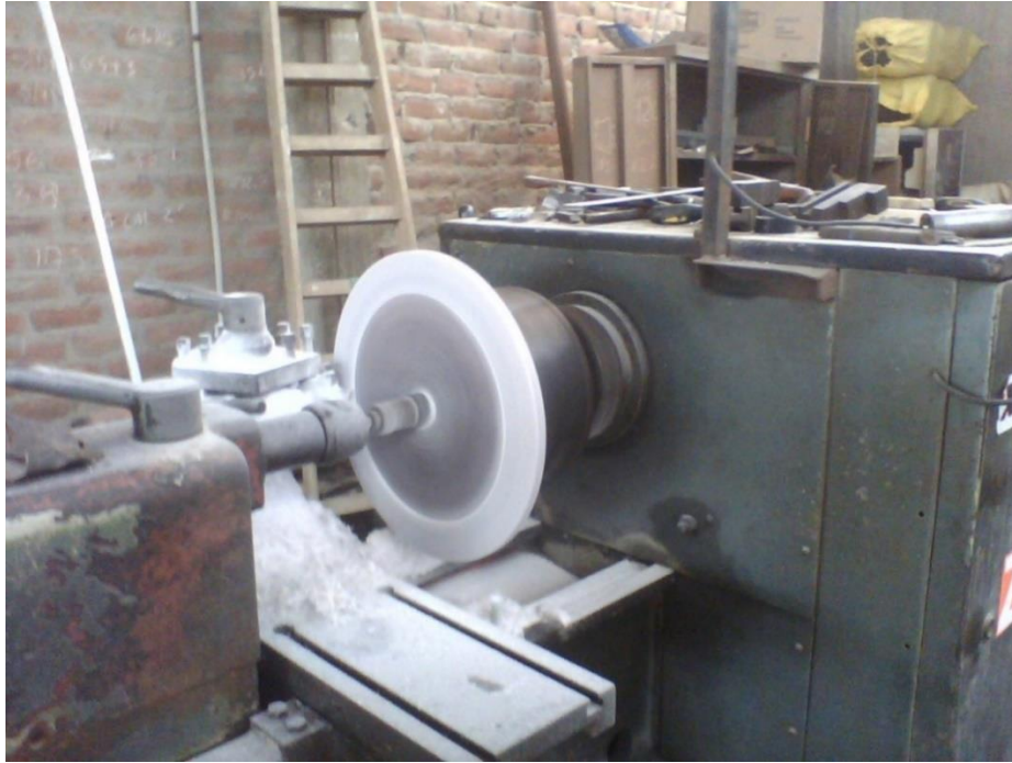
Figura 29: Mecanizando el espesor.
