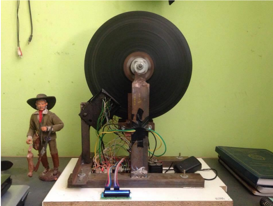
Figura 36: El motor funcionando a velocidad baja, alimentado solo con la batería de supercondensadores.
