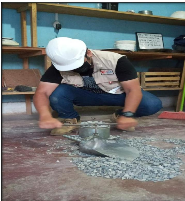
**Anexo 40:** Panel fotográfico N° 11 – Adición de los agregados para la elaboración del concreto  $f'c=210$  kg/cm<sup>2</sup>
