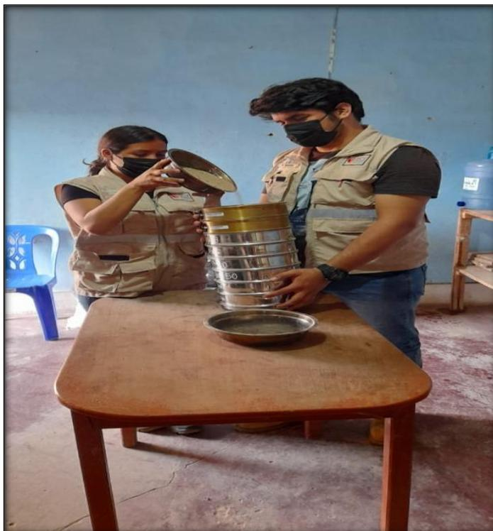
**Anexo 39:** Panel fotográfico N° 10 – Llenado del agregado grueso hasta la superficie del molde cilíndrico para el peso unitario compactado.
