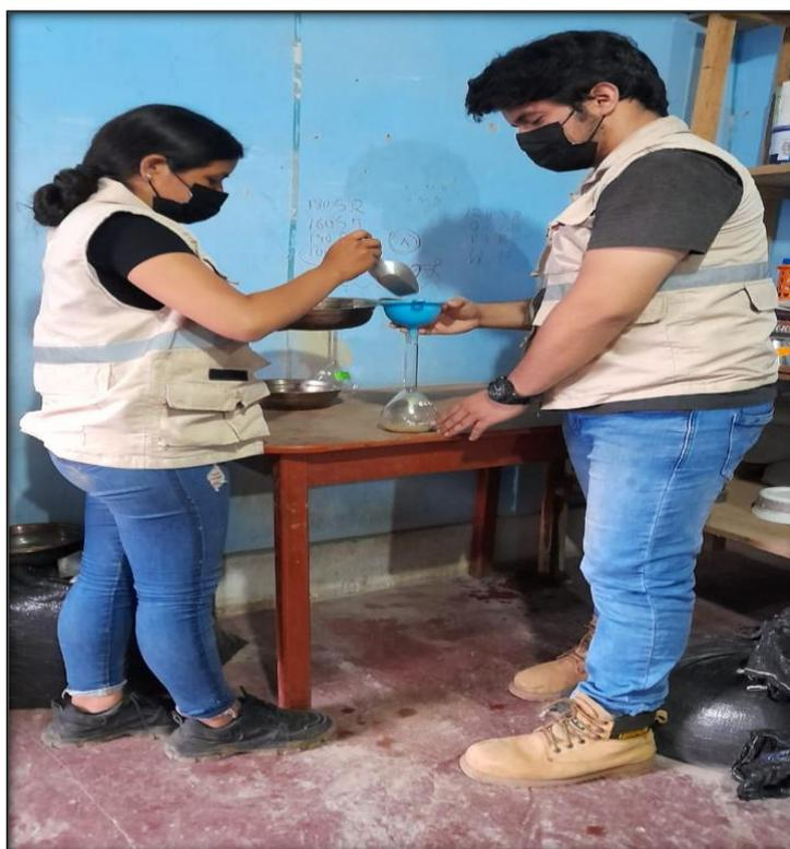
**Anexo 34:** Panel fotográfico N° 05 – Adición del agregado fino para el molde cilíndrico del peso unitario suelto.
