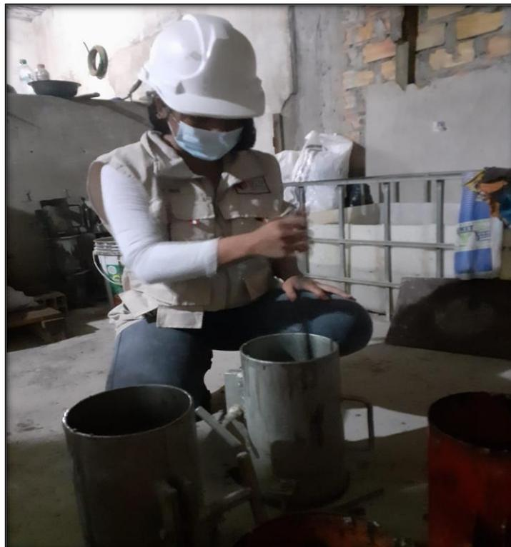
**Anexo 44:** Panel fotográfico N° 15 – Golpes con el martillo de goma para la elaboración de las probetas de concreto.
