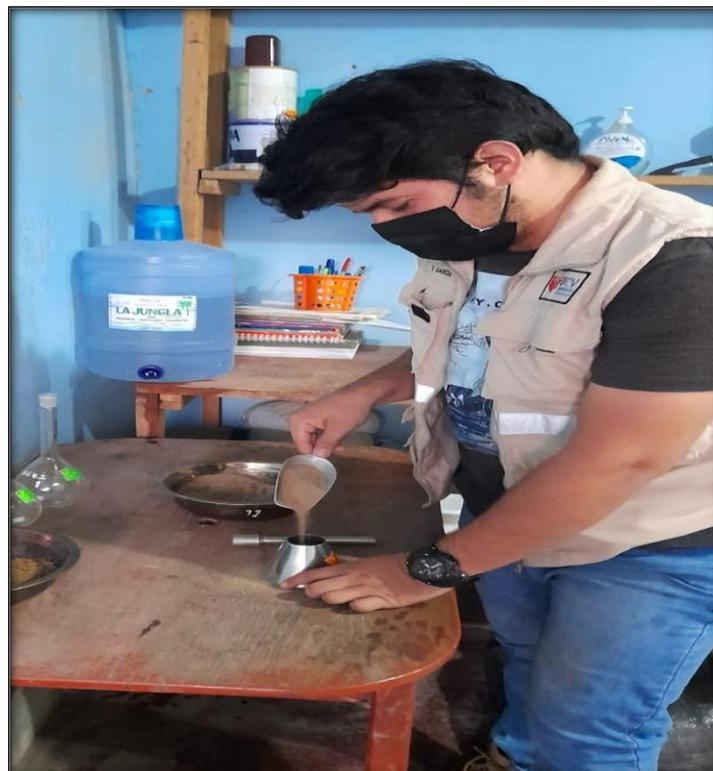
**Anexo 36:** Panel fotográfico N° 07 – Compactación con el pisón de absorción para el peso específico.
