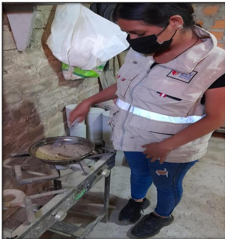
**Anexo 33:** Panel fotográfico N° 04 – Adición del agregado fino en proporción de 50/50 del peso total para cada fiola en relación al peso específico.
