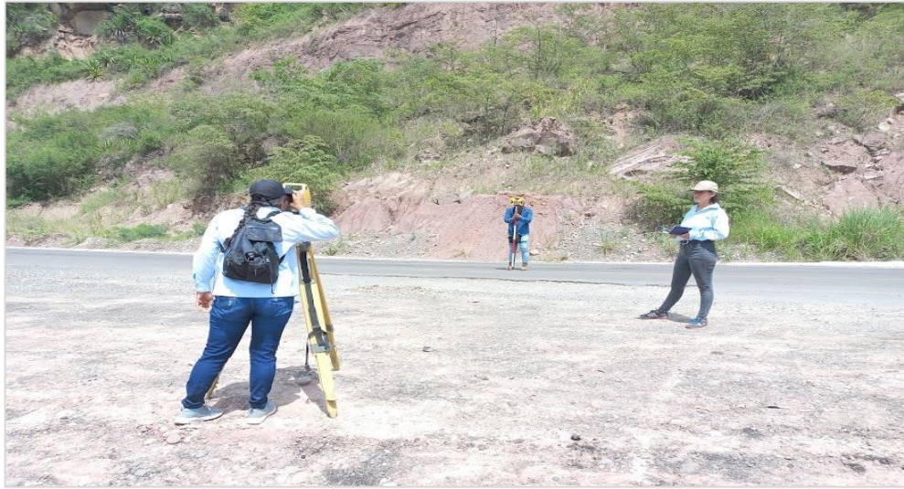
Figura 11: Levantamiento topográfico y anotaciones en la libreta de campo
