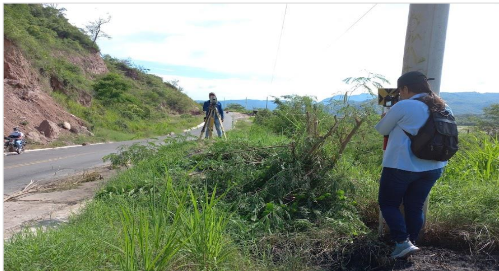
Figura 6: Levantamiento topográfico con la estación total y el prisma
