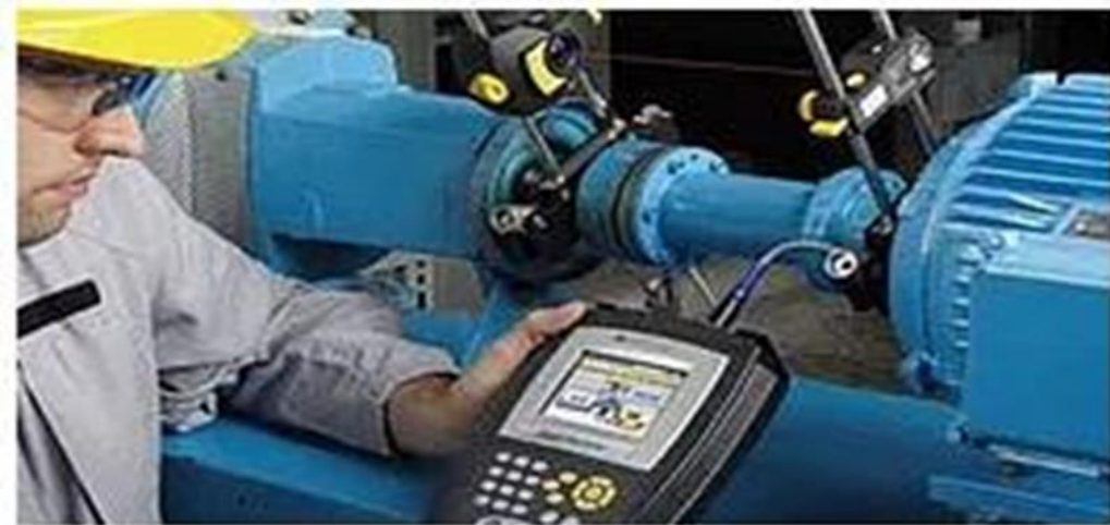
Figura 35 Análisis vibracional – Técnicas del mantenimiento predictivo
