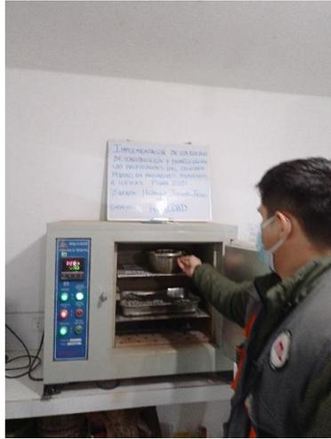
Fotografía 9. Colocación de la muestra del agregado grueso en el horno para el contenido de humedad
