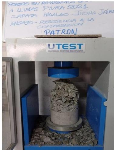
Fotografía 17. Probeta patrón ensayada a resistencia a la compresión
