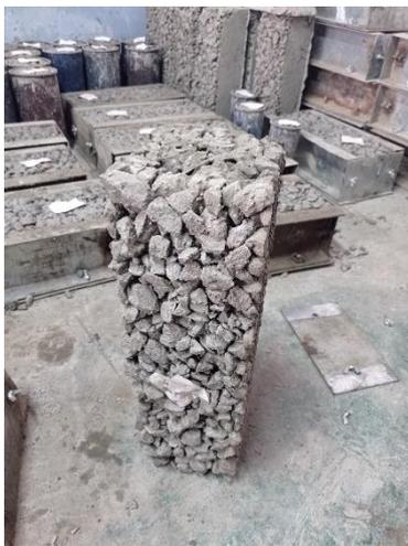
Fotografía 15. Viga en concreto poroso con implementación de residuos de construcción al 20%
