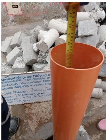
Fotografía 31. Ensayo de permeabilidad en probeta con el 40% de agregado reciclado
