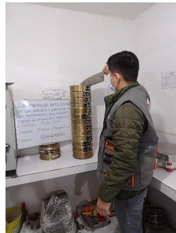
Fotografía 8. Ensayo de granulometría para el agregado grueso
