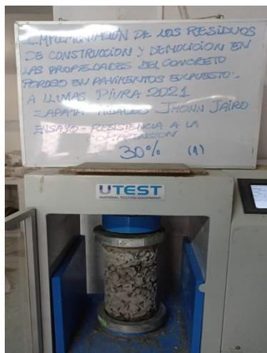
Fotografía 19. Probeta de 14 días de edad con 30% de agregado reciclado lista para ensayar
