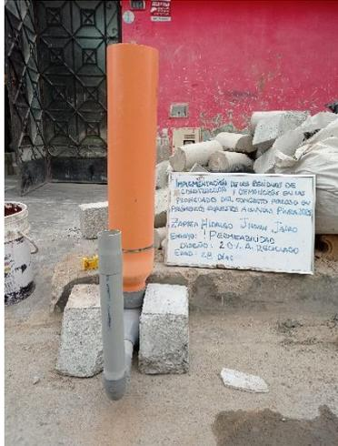
Fotografía 29. Equipo casero para realizar el ensayo de permeabilidad
