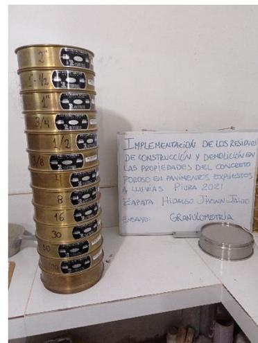
Fotografía 12. Mallas para el ensayo de granulometría
