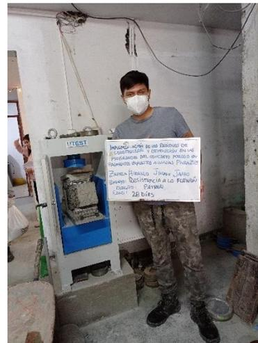
Fotografía 22. Viga ensayada a los 28 días de edad diseño patrón
