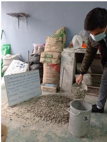
Fotografía 3. Ensayo de peso unitario del agregado grueso (suelto)
