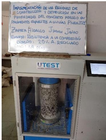
Fotografía 21. Colocación de probeta en la prensa hidráulica
