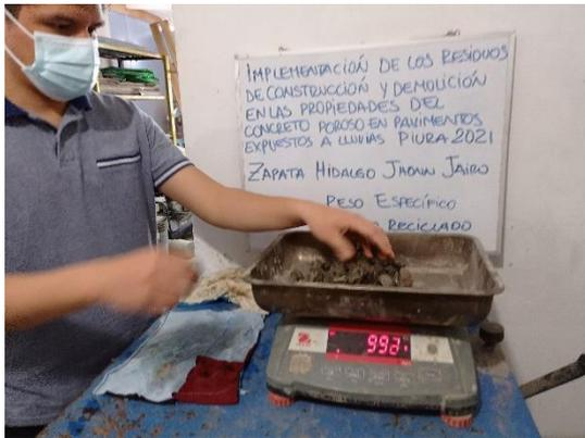
Fotografía 11. Ensayo de peso específico para el material reciclado
