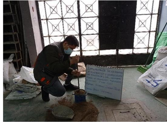
Fotografía 6. Ensayo de peso unitario del agregado fino (compactado)
