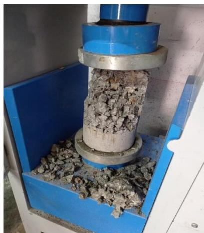
Figura 12. Probeta de concreto poroso ensayada por resistencia a la compresión con 7 días de edad
