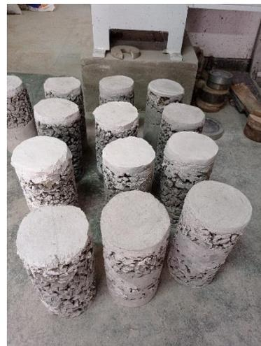
Fotografía 16. Capeado de probetas en concreto poroso, listas para ser ensayadas
