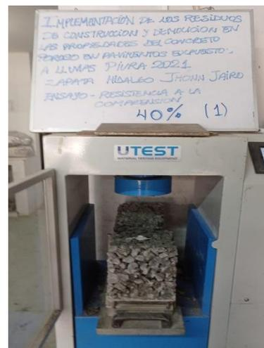
Fotografía 20. Viga con 40% de agregado reciclado lista para ser ensayada
