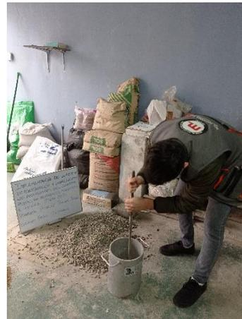
Fotografía 4. Ensayo de peso unitario del agregado grueso (compactado)
