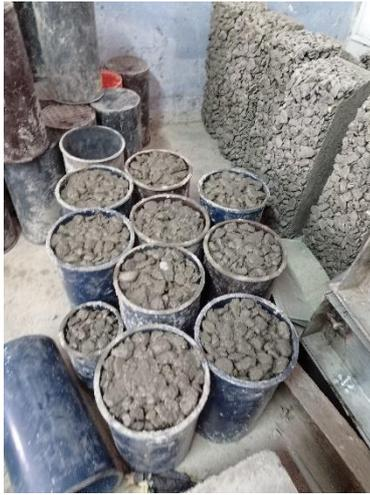
Fotografía 13. Probetas en concreto poroso diseño patrón, 20%, 30%, 40%
