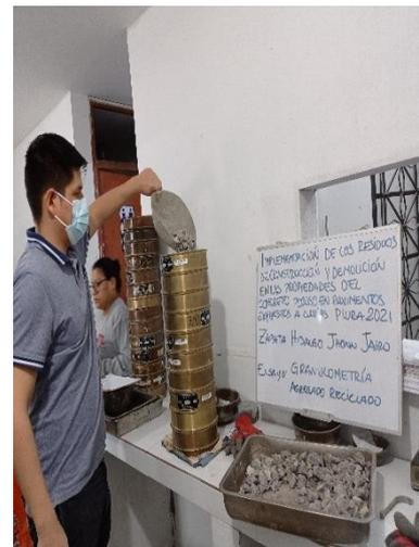
*Figura 6. Granulometría del agregado reciclado*
