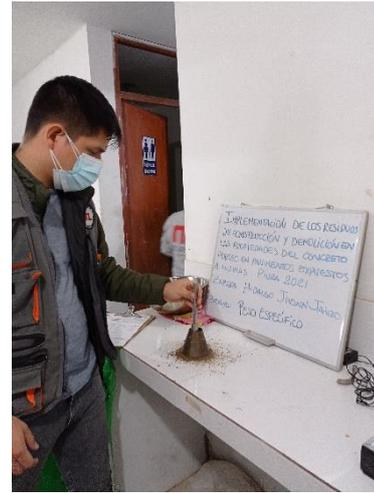
Fotografía 10. Peso específico del agregado fino (utilización del pisón)
