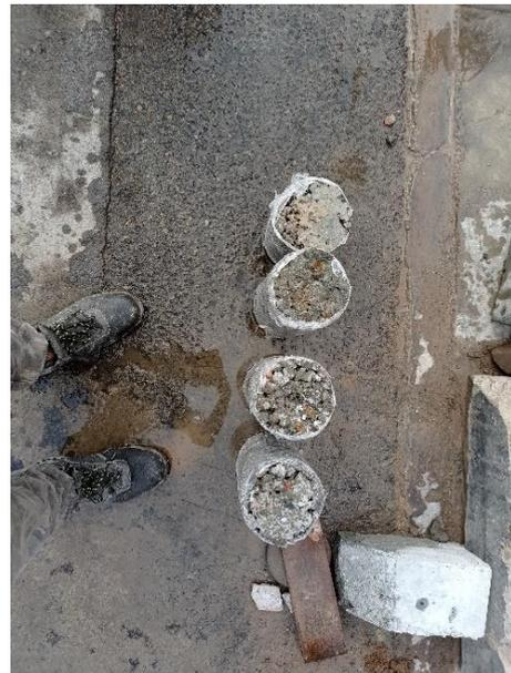
*Figura 18.* Probetas en concreto poroso ensayadas por permeabilidad con 28 días de edad
