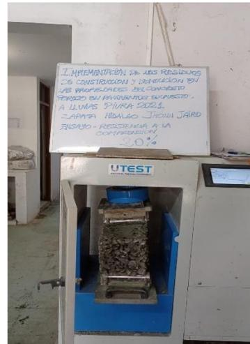
Fotografía 26. Viga con 20% de agregado reciclado ensayada
