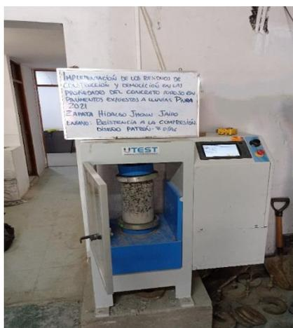
Figura 11. Ensayo de resistencia a la compresión en probeta de concreto poroso a los 7 días de edad
