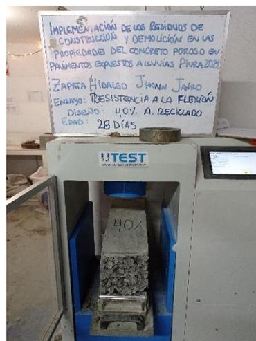
Fotografía 24. Viga con 40% de agregado reciclado lista para ser ensayada
