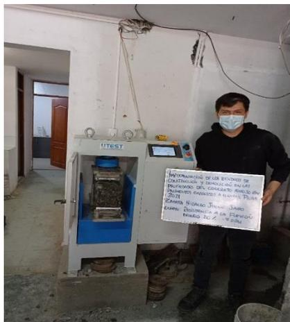
Figura 14. Ensayo de resistencia a la flexión en secciones de vigas de concreto poroso a los 7 días de edad
