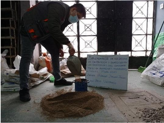
Fotografía 5. Ensayo de peso unitario del agregado fino (suelto)
