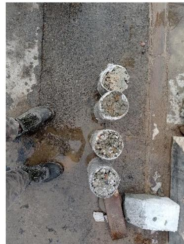
Fotografía 32. Probetas ensayadas en permeabilidad a los 28 días de edad
