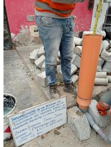
Fotografía 30. Ensayo de permeabilidad a probeta con el 20% de agregado reciclado
