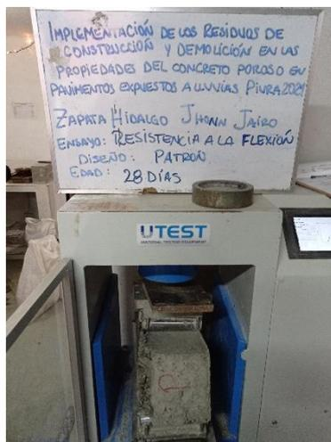
Fotografía 27. Viga patrón ensaya en la prensa hidráulica
