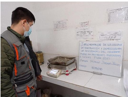
Fotografía 7. Ensayo de contenido de humedad en agregado grueso
