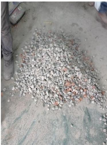
*Figura 4. Concreto y ladrillo reciclado*
