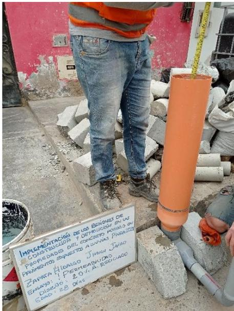
*Figura 17.* Ensayo de permeabilidad en probetas de concreto poroso a los 28 días de edad
