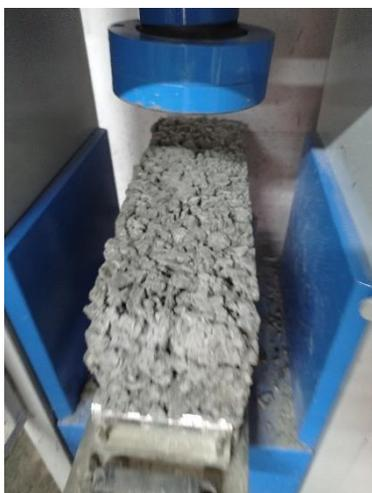
Fotografía 23. Viga en prensa hidráulica lista para ser ensayada
