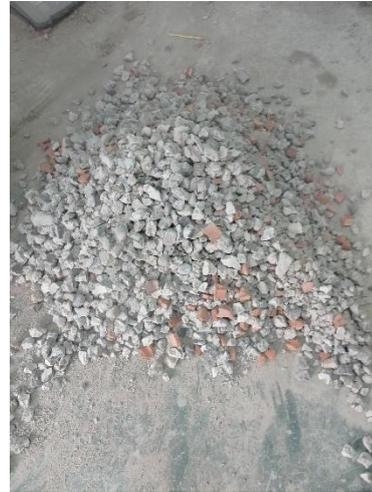
Fotografía 2. Residuos de construcción y demolición (concreto y ladrillo) de 3/8" a 3/4"
