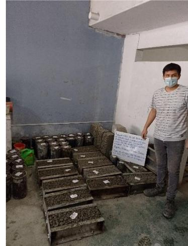
Fotografía 14. Probetas (40 und) y vigas (24 und) encofrados para posterior ensayo
