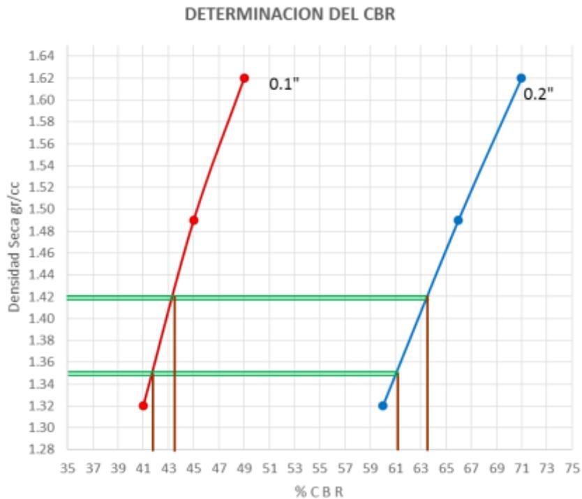
Figura 6. Ensayo CBR para la muestra (M – 1) + 5 % de cabuya
