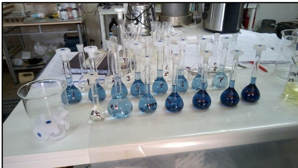
**Figura 23:** Análisis de fósforo mediante el método de espectrofotometría
