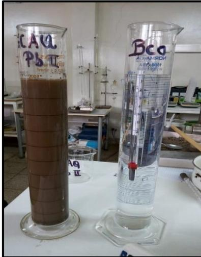
Figura 18: Análisis mediante ASTM-152H
