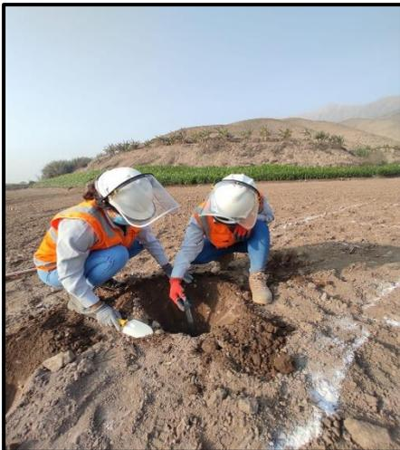
**Figura 8:** Obtención de la muestra de suelo
