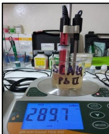
Figura 16: Medición de Potencial Redox
