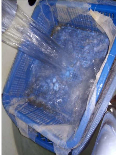
Figura 10: Filtro de excretas para el tanque de recirculación de agua
