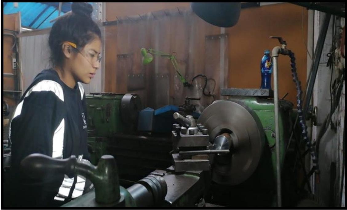
Figura 12. Falta de equipos de protección
