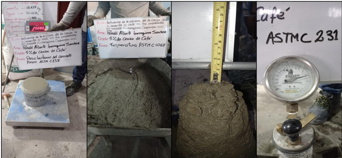
Ensayos en el concreto fresco (5% de ceniza de cascarilla de café)
