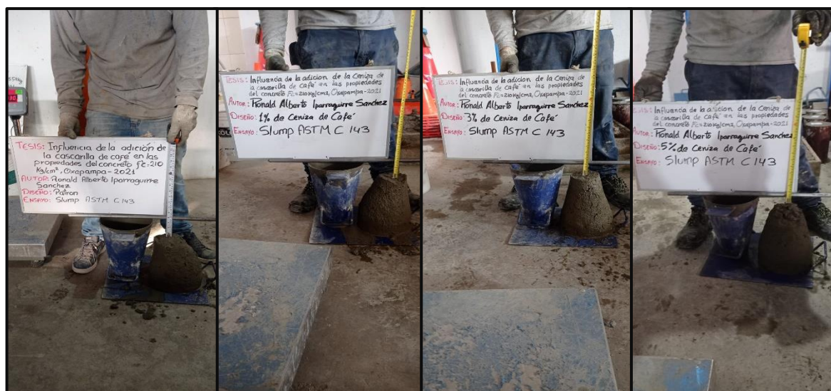
Figura 12: Ensayo de consistencia del concreto en laboratorio
