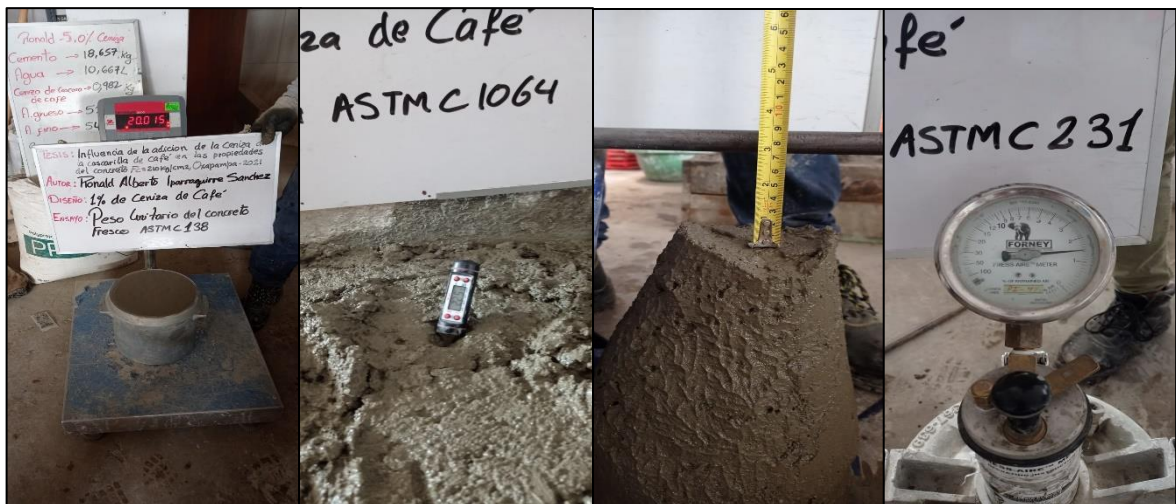
Ensayos en el concreto fresco (1% de ceniza de cascarilla de café)
