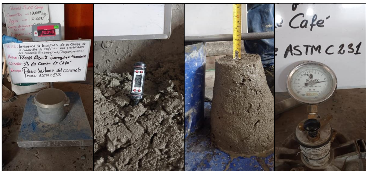
Ensayos en el concreto fresco (3% de ceniza de cascarilla de café)
