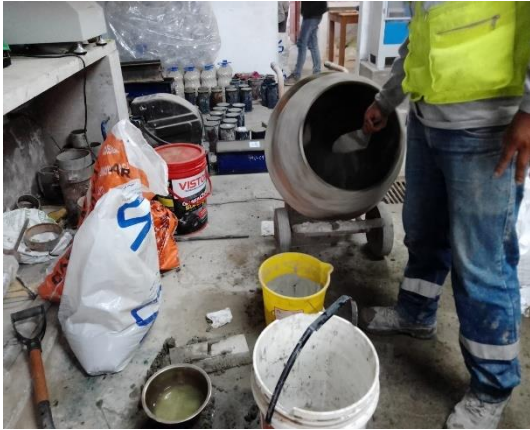
Preparación de muestras de concreto
