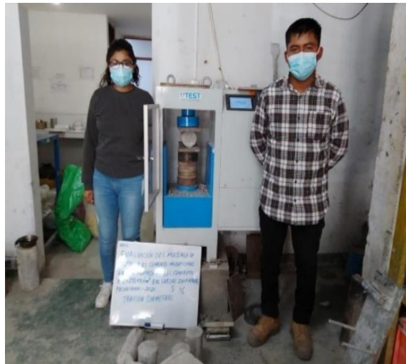
Ensayo a la tracción
