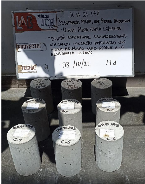
Figura 6. Probetas desmoldadas a los 14 días antes de ensayo de rotura.
