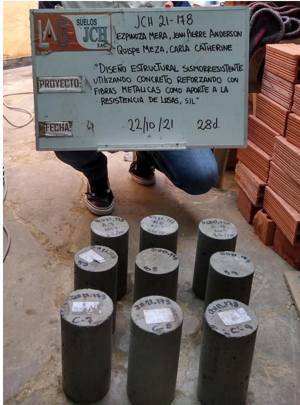
Figura 8. Probetas desmoldadas a los 28 días antes de ensayo de rotura. Fuente: Elaboración propia
