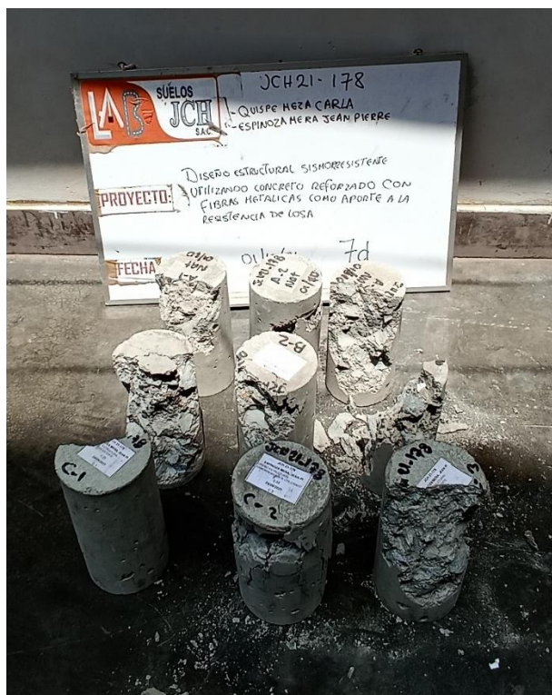
Figura 5. Probetas desmoldadas a los 7 días después de ensayo de rotura.
