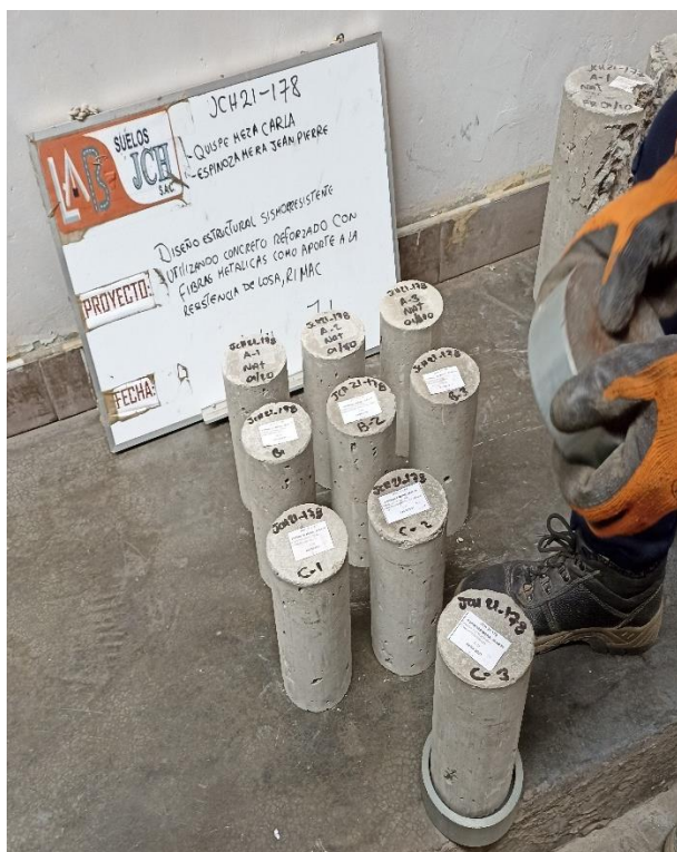
Figura 4. Probetas desmoldadas a los 7 días antes de ensayo de rotura.
