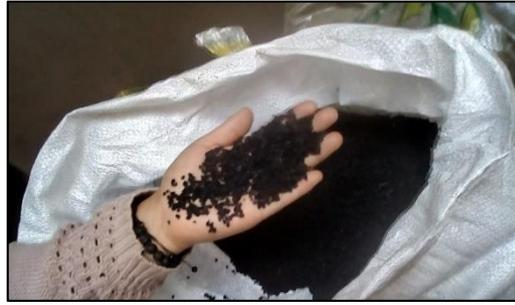
Figura 246. Partículas de caucho triturado de 2.5mm
