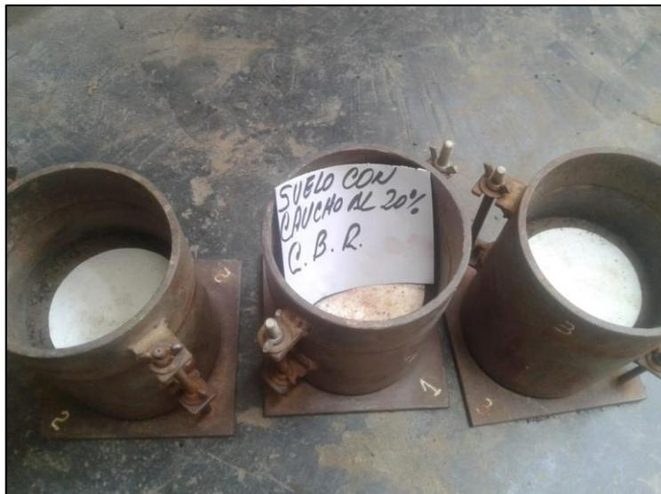
Anexo 3092. Ensayo de CBR con 30% de caucho
