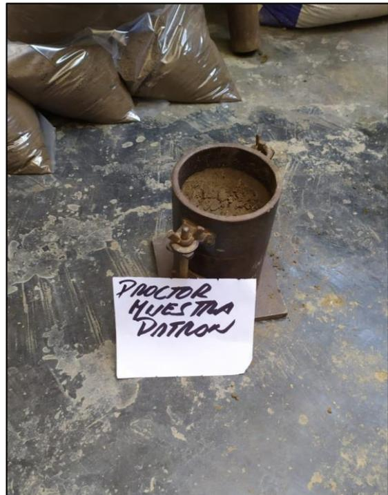
Anexo 3068. Ensayo de CBR con 10% de caucho triturado
