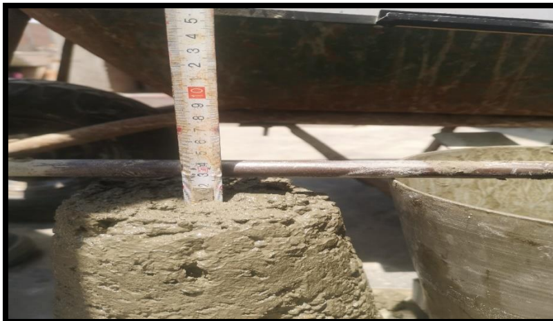
Figura 3. Medición de la trabajabilidad del concreto mediante el cono de abrahams Fuente: Elaboración propia
