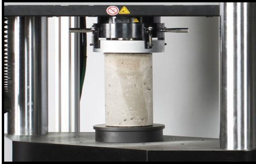
Figura 2: Ensayo de resistencia a la compresión de probetas cilíndricas de concreto Fuente: Ponce (2016).
