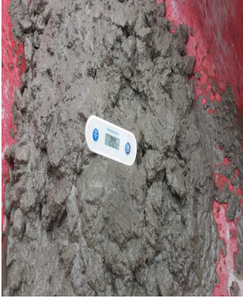
Fotografía N° 21. Toma de temperatura interna del concreto con adición de CCA.
