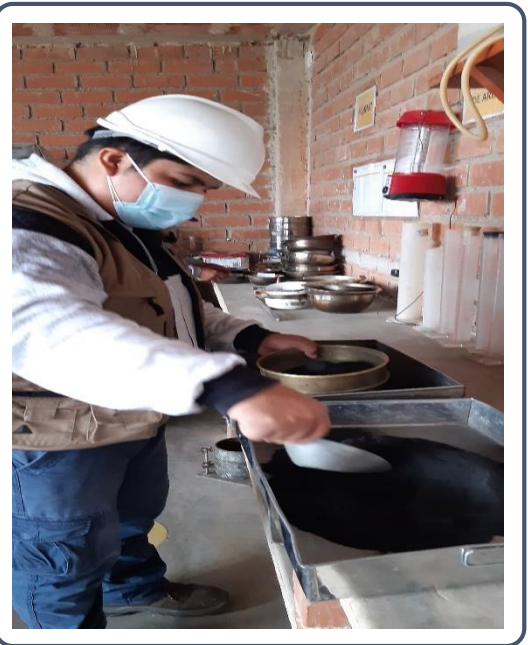
Fotografía N° 15. Tamizado de ceniza de cascarilla de arroz para su empleo en el concreto.
