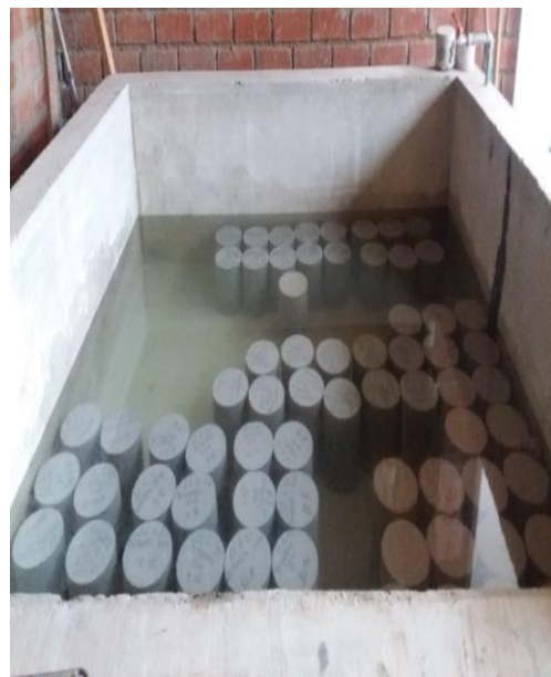
Fotografía N° 24. Curado de probetas de concreto patrón y adicionadas parcialmente con CCA.
