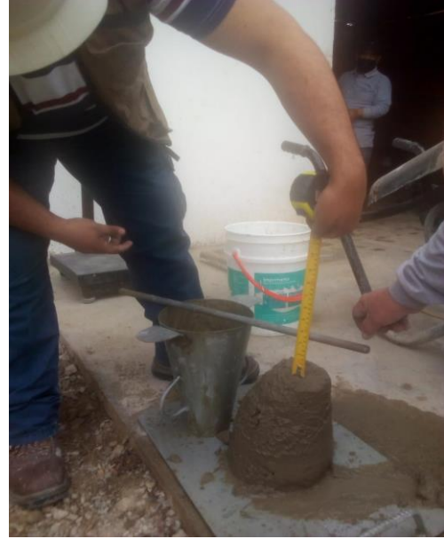
Fotografía N° 22. Ensayo de asentamiento del concreto adicionado.
