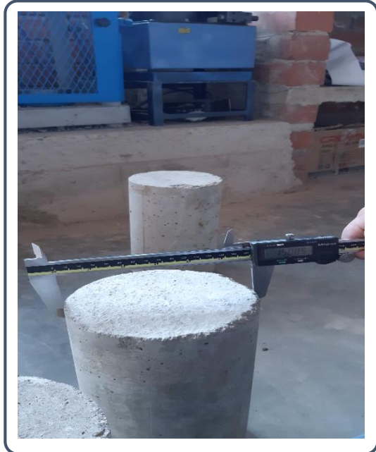
Fotografía N° 26. Toma de medidas (diámetro), con vernier para los especímenes.
