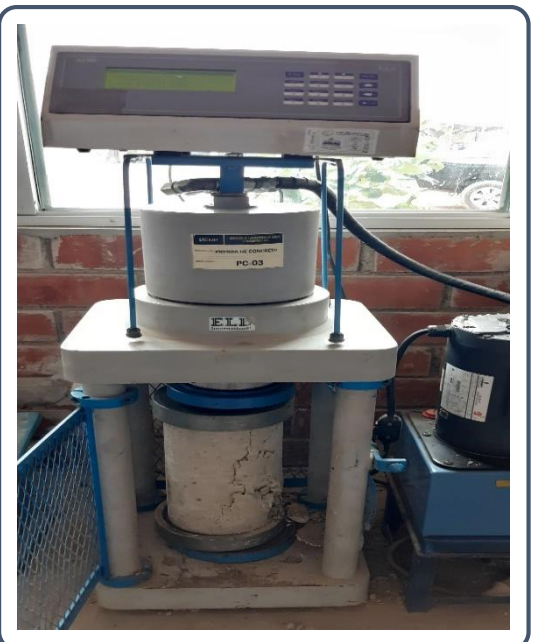
Fotografía N° 27. Ensayo de resistencia a compresión del concreto patrón a diferentes edades.
