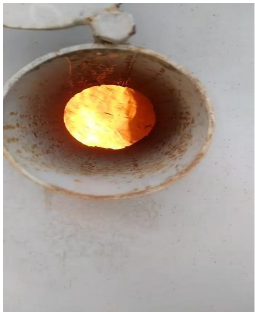
Fotografía N° 5. Servicio de quemador a base de cascarilla de arroz para secado de arroz.
