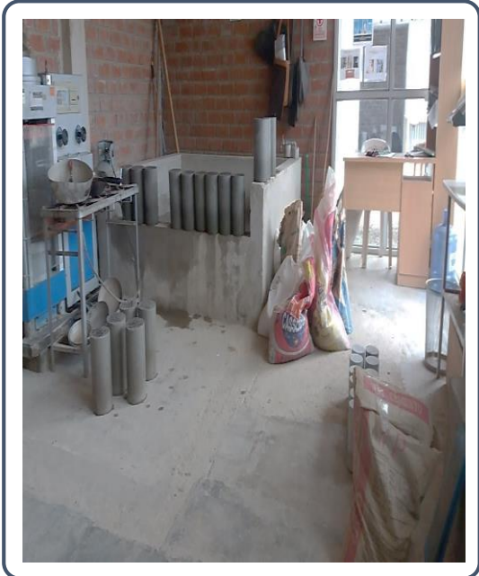
Fotografía N° 25. Retiro de especímenes de cisterna de curado a edades de 7,14 y 28 días.
