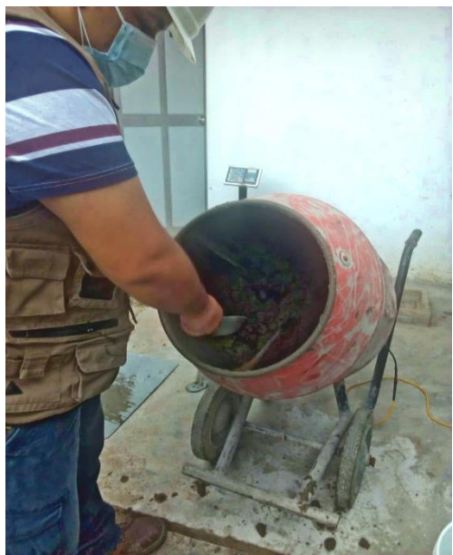
Fotografía N° 17. Mezclado del concreto patrón con la dosificación establecida.
