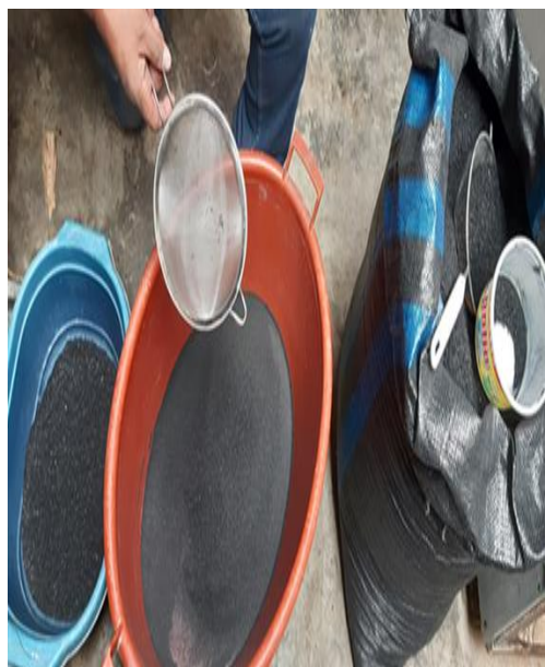
Fotografía N° 7. Tamizado inicial de ceniza y separación de residuos con colador de malla fina.
