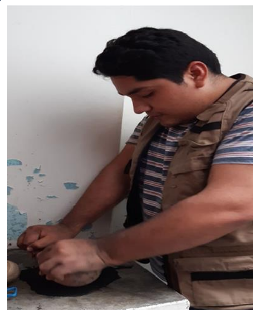
Fotografía N° 8. Proceso de pulverizado manual de ceniza de cascarilla de arroz y su posterior tamizado.
