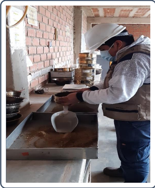
Fotografía N° 13. Ensayo de granulometría para el agregado fino.
