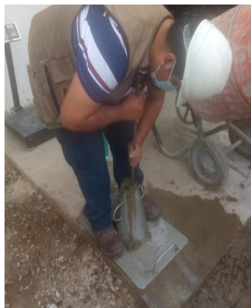
Fotografía N° 18. Ensayo de asentamiento (Slump en pulgadas), del concreto patrón
