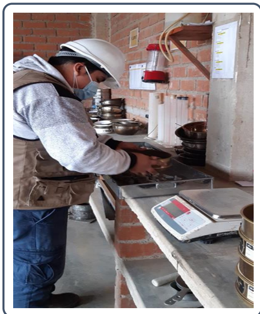
Fotografía N° 11. Ensayo de granulometría para el agregado grueso.
