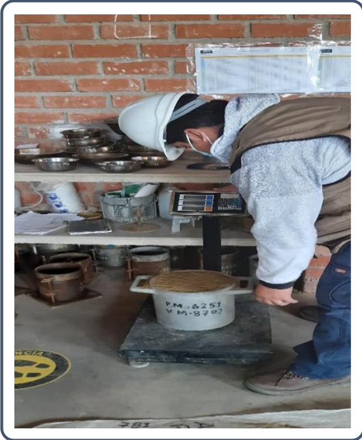
Fotografía N° 14. Ensayo de peso unitario compactado para agregado fino.
