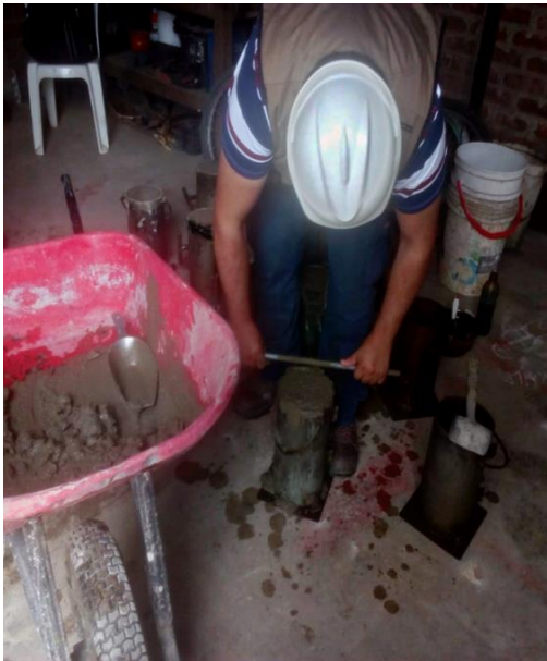
Fotografía N° 23. Elaboración de especímenes de concreto patrón y adicionado con CCA.
