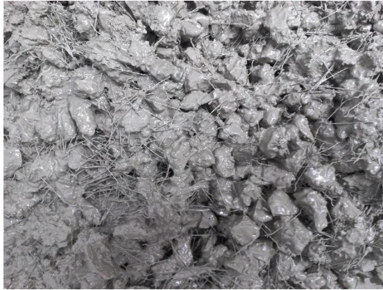
Figura 39. Mezcla de concreto con fibra de acero
