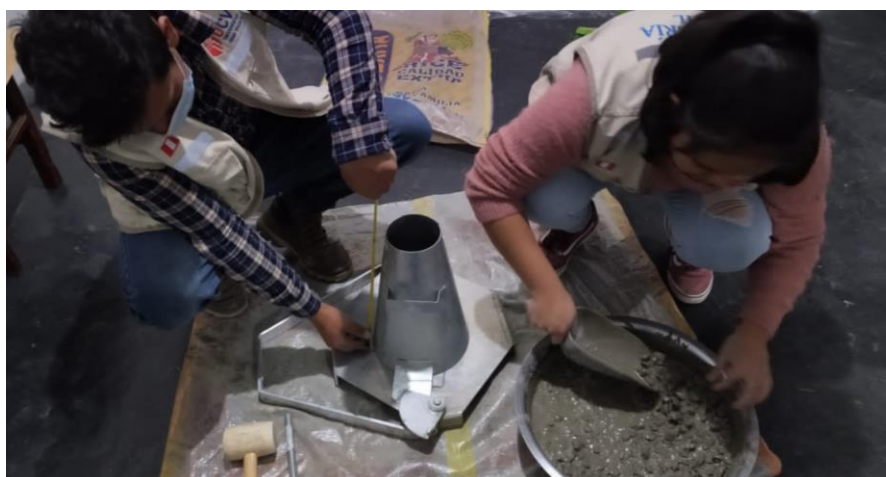
Figura 42. Ensayo de asentamiento
