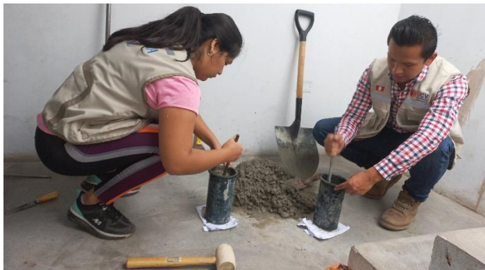
Figura 43. Ensayo de peso unitario en el concreto fresco
