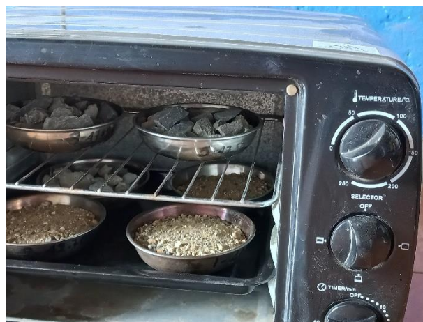
Figura 36. Secado del material para contenido de humedad Una vez registrados los pesos, estos fueron procesados empleando la siguiente fórmula:
