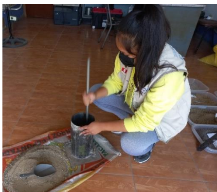
Figura 30. Envarillado para peso unitario compactado
