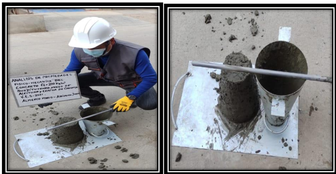
Figura 23. Prueba de Slump
