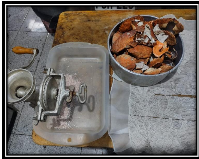
Figura 5. Triturado de caparazón
