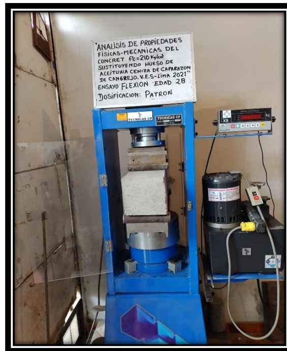
Figura 28. Ensayo de vigas a flexión
