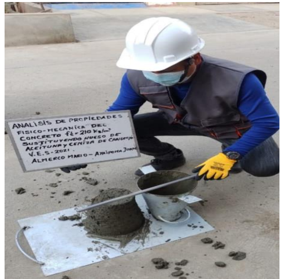
Fotografía 12: Determinación de Slump
