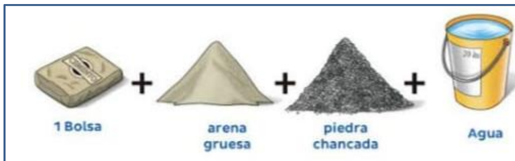
Figura 19. Materiales empleados en preparación del concreto
