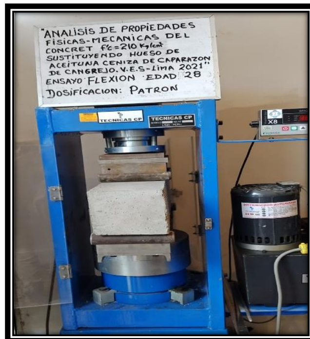
Figura 58. Ensayo a flexión al concreto, 28 días
