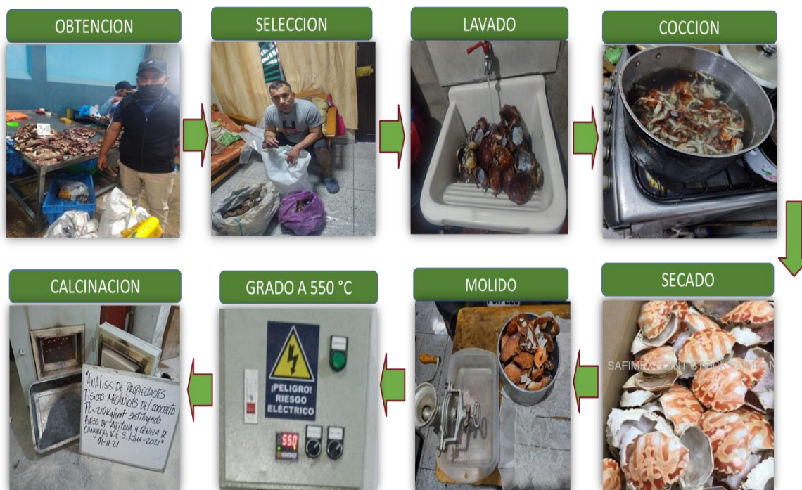
Figura 17. Procesos de Obtención de ceniza, H. Aceituna
