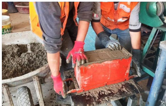
Figura 12. Elaboración de bloques.
