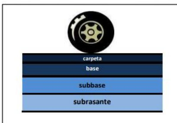
**FIGURA 1.** Estructura de un pavimento flexible
