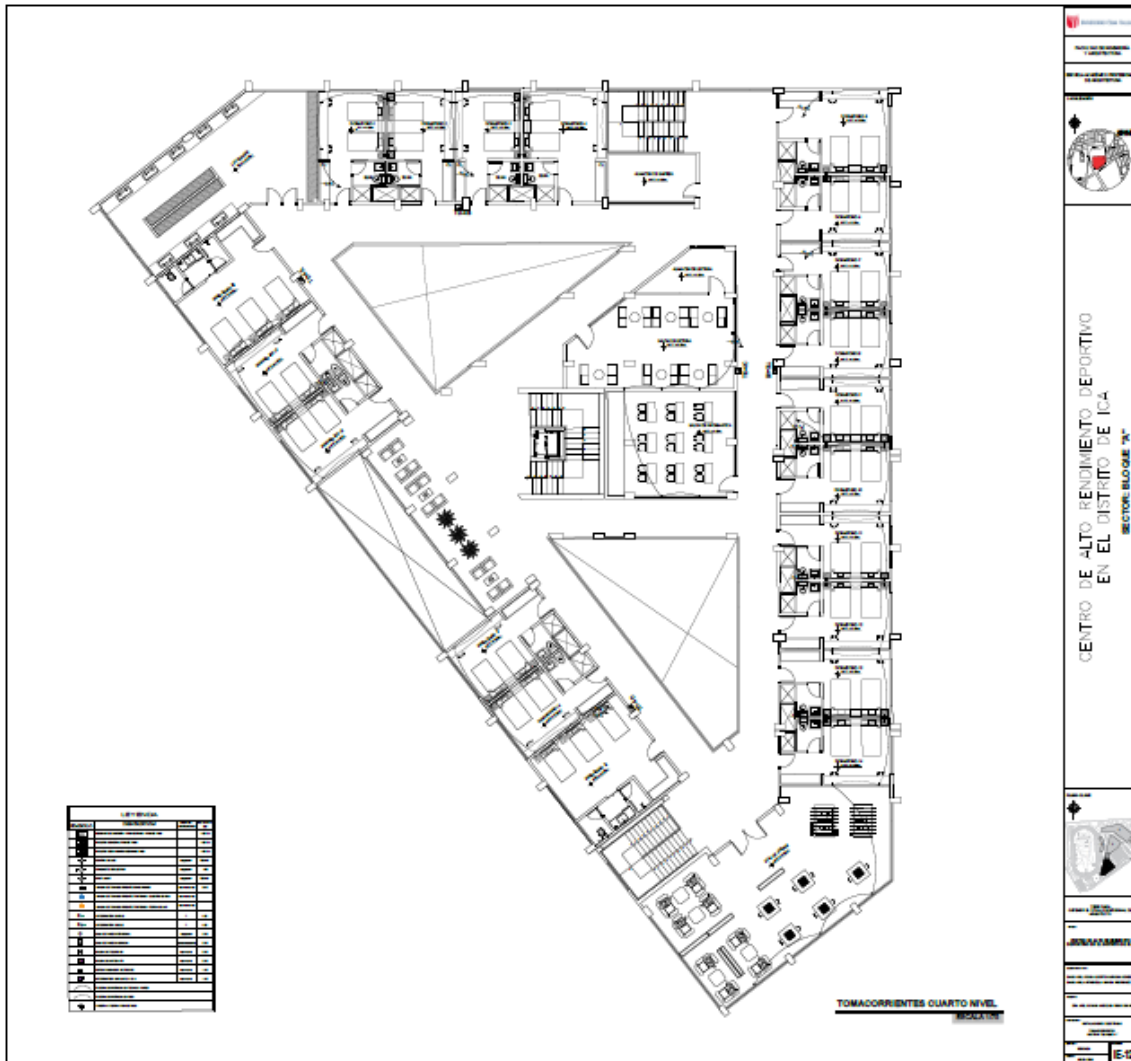
IE-12 Instalaciones Eléctricas – Tomacorrientes Cuarto Nivel Bloque “A”.
