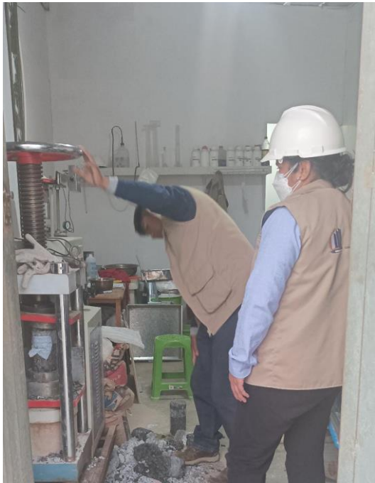
ENSAYO ROTURA CONCRETO PERMEABLE
