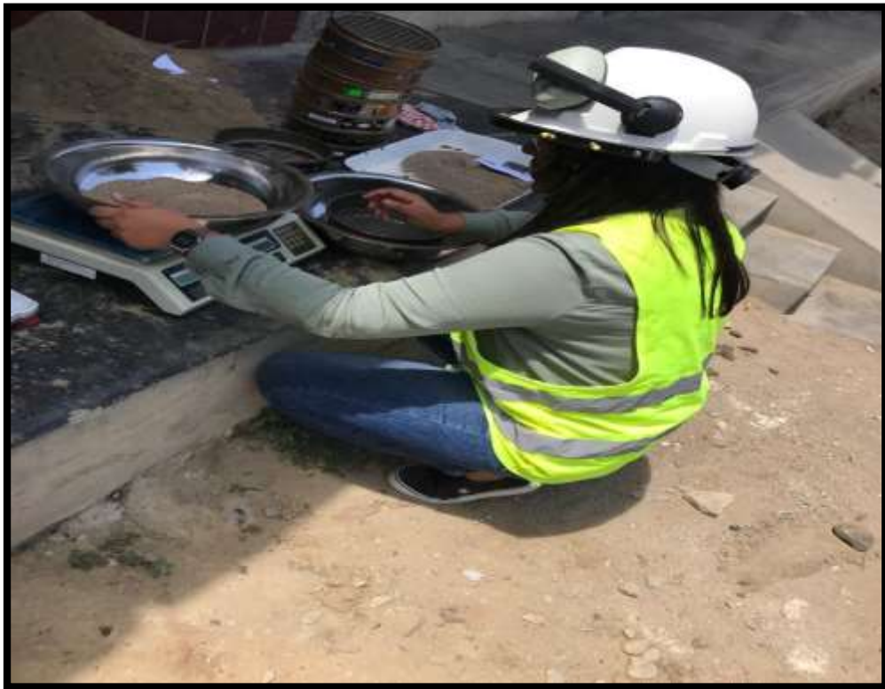
Figura N° 35: Ensayo de granulometría
