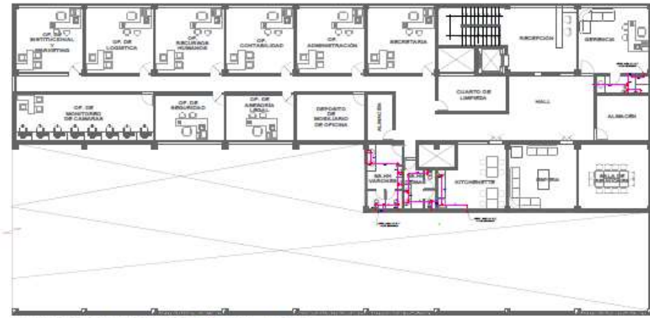
SECTOR A-TERCER PISO - Agua ESC: 1/100
