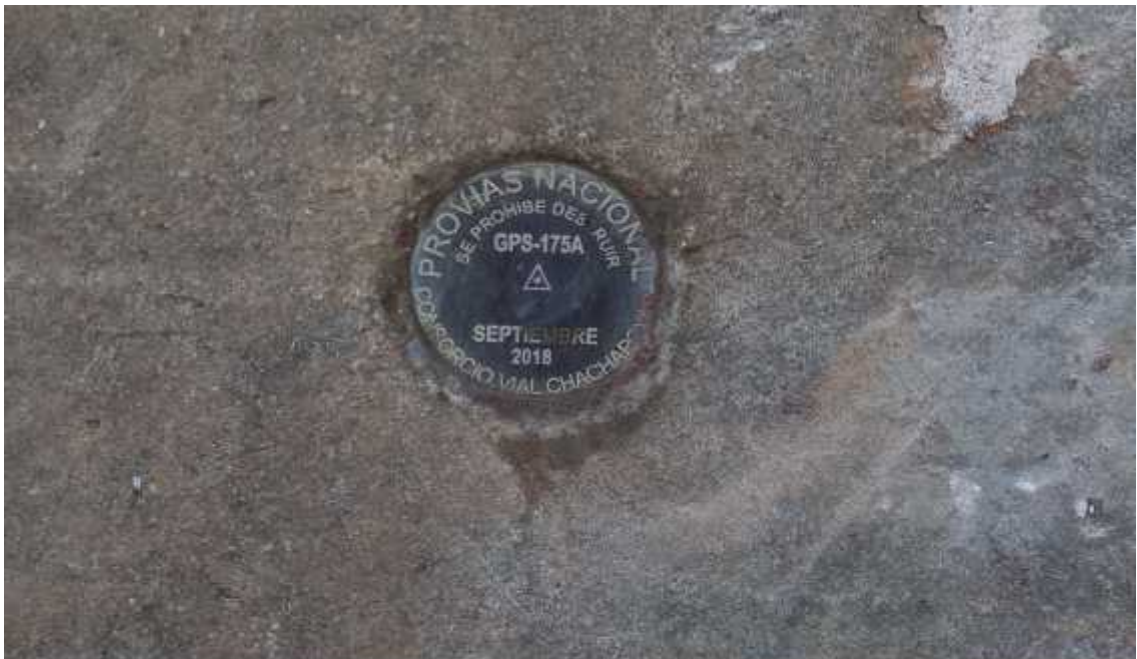
Fotografía 2. “Punto base geodésico GPS – 175A Registrado por Provias Nacional con fecha setiembre 2018”
