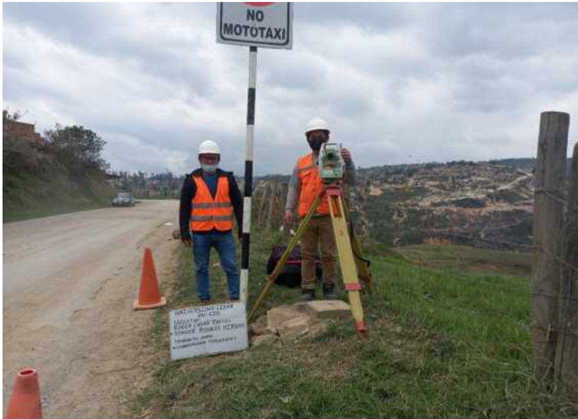
Fotografía 3. "Inicio de levantamiento topográfico desde el punto geodésico "
