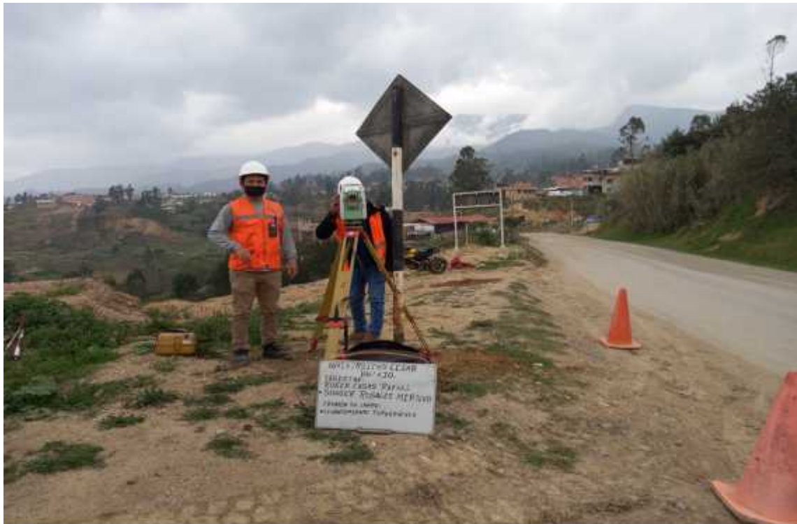
Fotografía 5. "Realizando el levantamiento en el punto geodésico GPS-175A con equipo topográfico estación total marca Leica modelo NA730"
