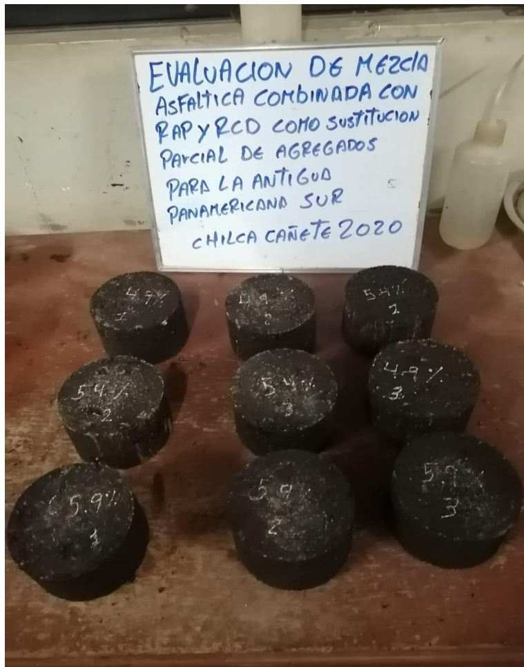
Figura 18. Briquetas con porcentajes de asfalto para la muestra patrón.
