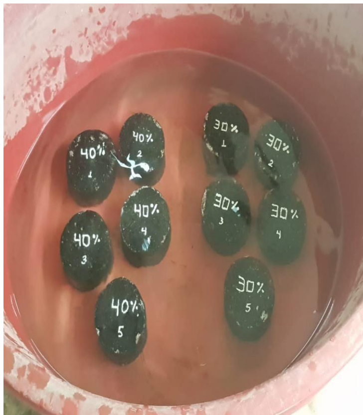
Figura 22. Briquetas con RAP y RCD
