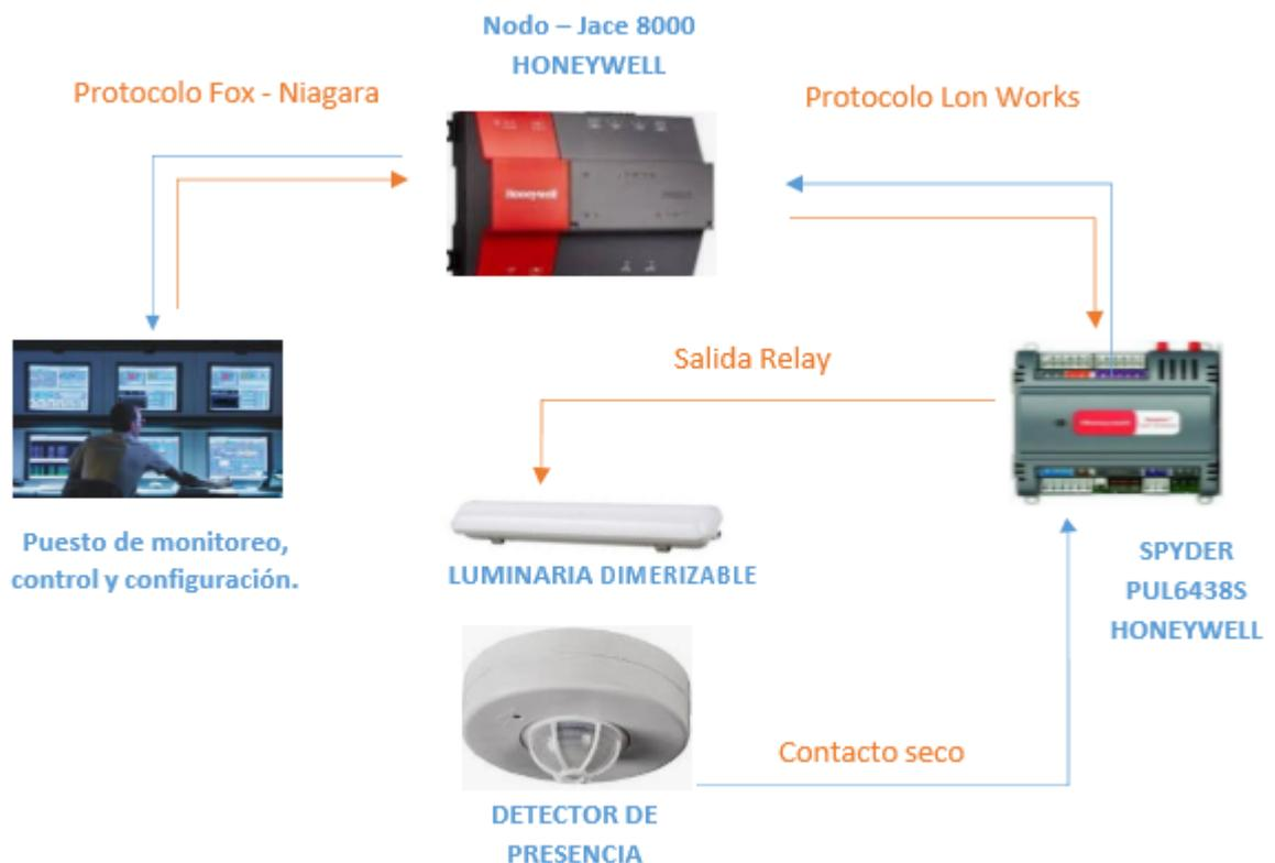
Figura 9. Sistema de control y monitoreo de la especialidad, luminarias.
