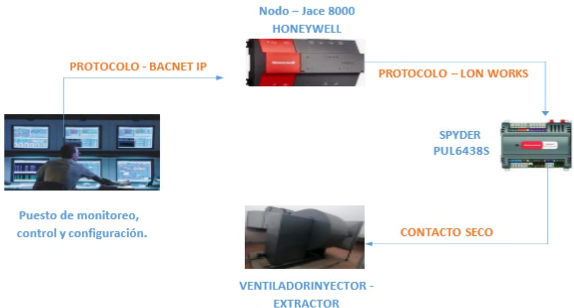
Figura 8. Sistema de control y monitoreo ventilador forzado.
