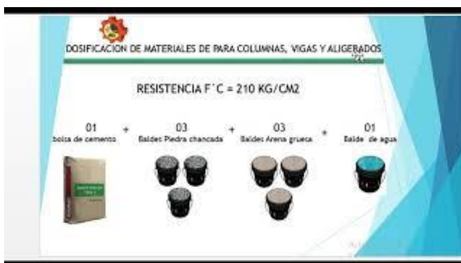
Figura N° 10 dosificación de materiales
