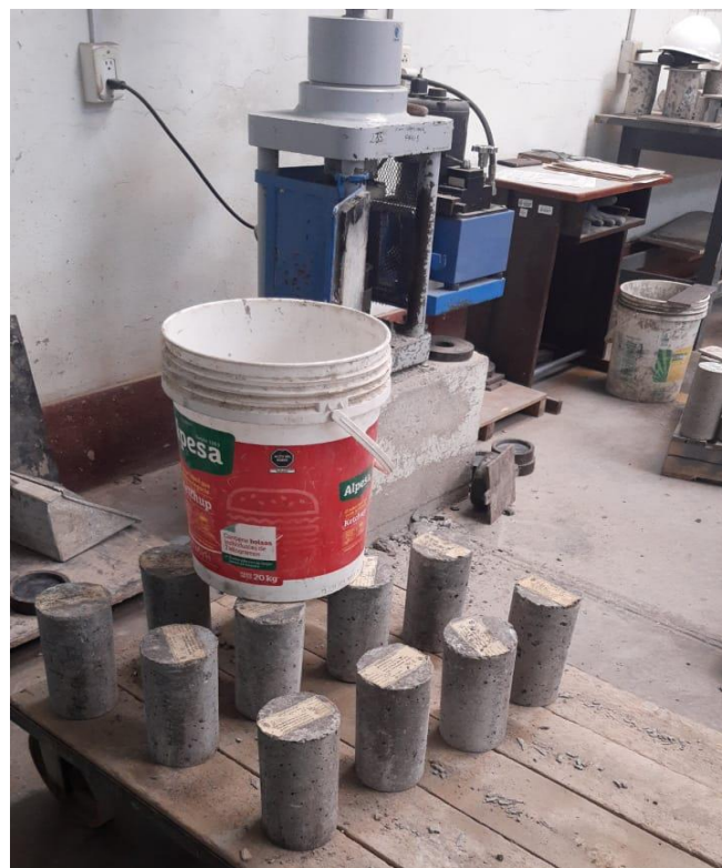
Probetas con 14 días de curado
