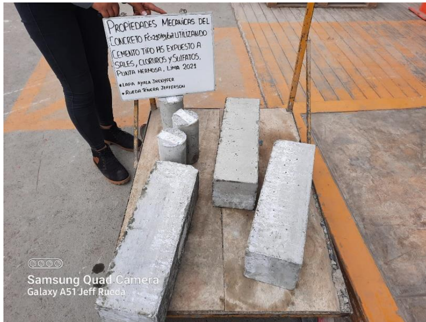
Probetas y vigas con 7 días de curado
