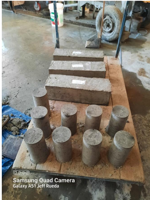
Probetas y vigas con 28 días de curado
