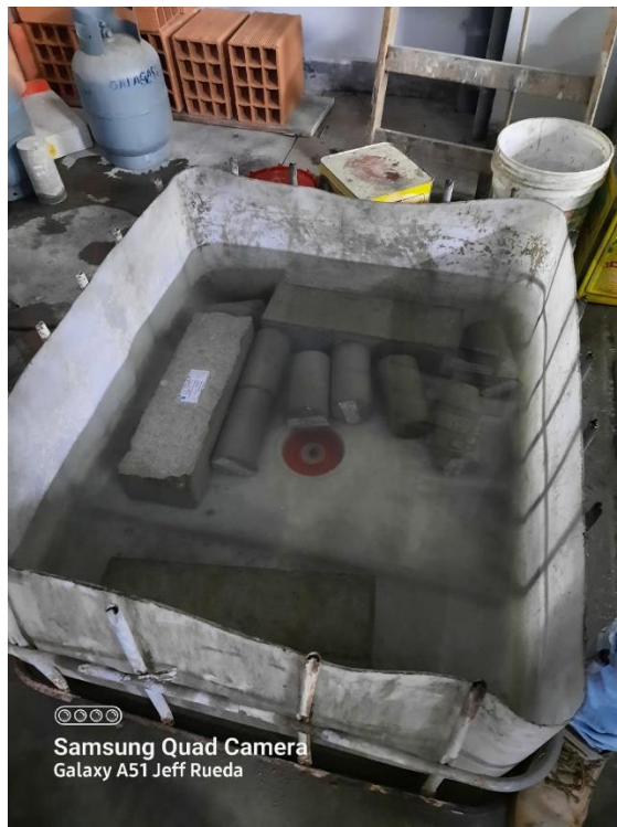
Probetas y vigas expuestas a sales, cloruros y sulfatos
