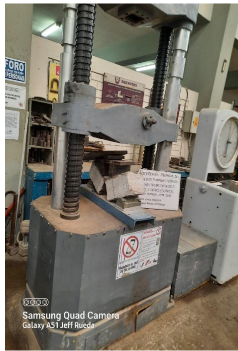
Rotura en viga
