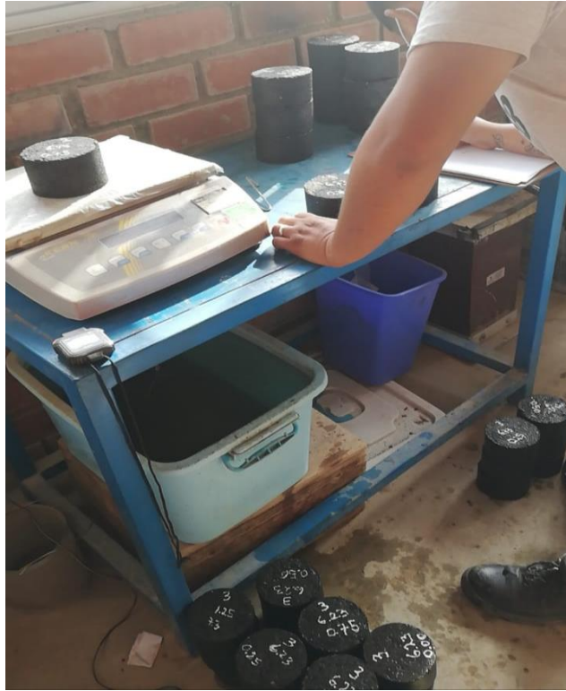
Figura 52: Ejecución de ensayo RICE.
