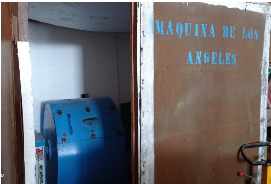
Figura 25: Maquinaria para ensayo de abrasión (máquina de los ángeles).
