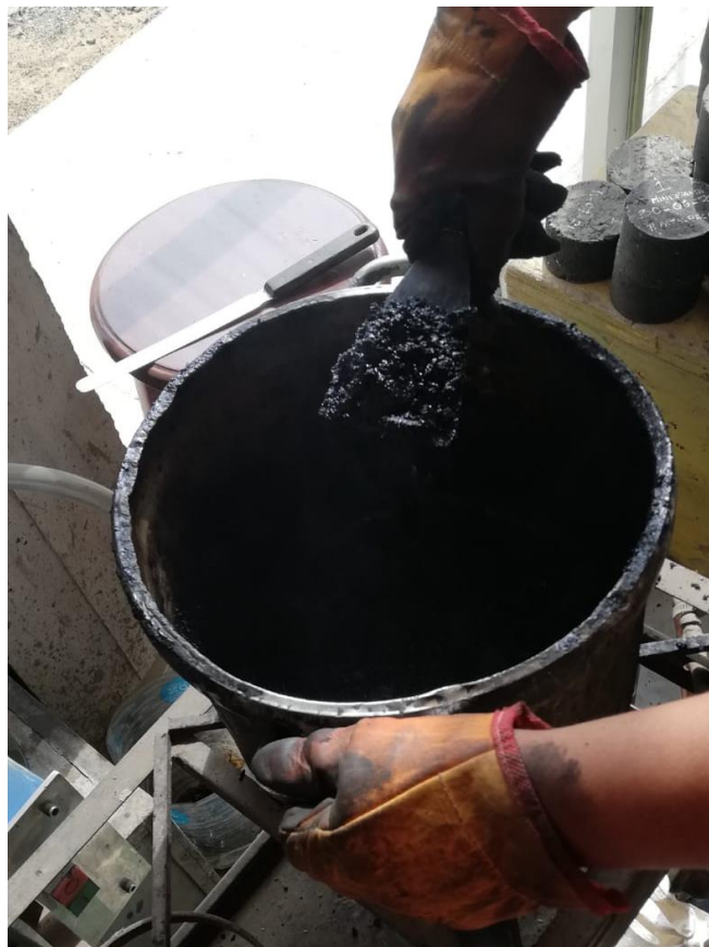
Figura 45: Resultado de la elaboración de mezcla asfáltica en caliente.
