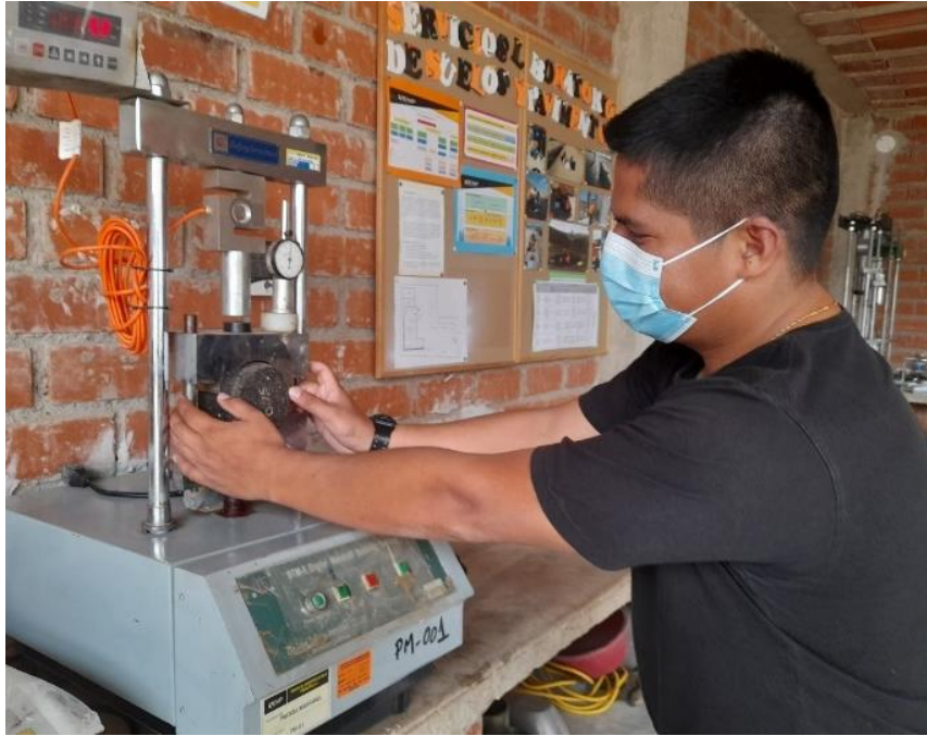
Figura 55: Realización de ensayo Marshall.
