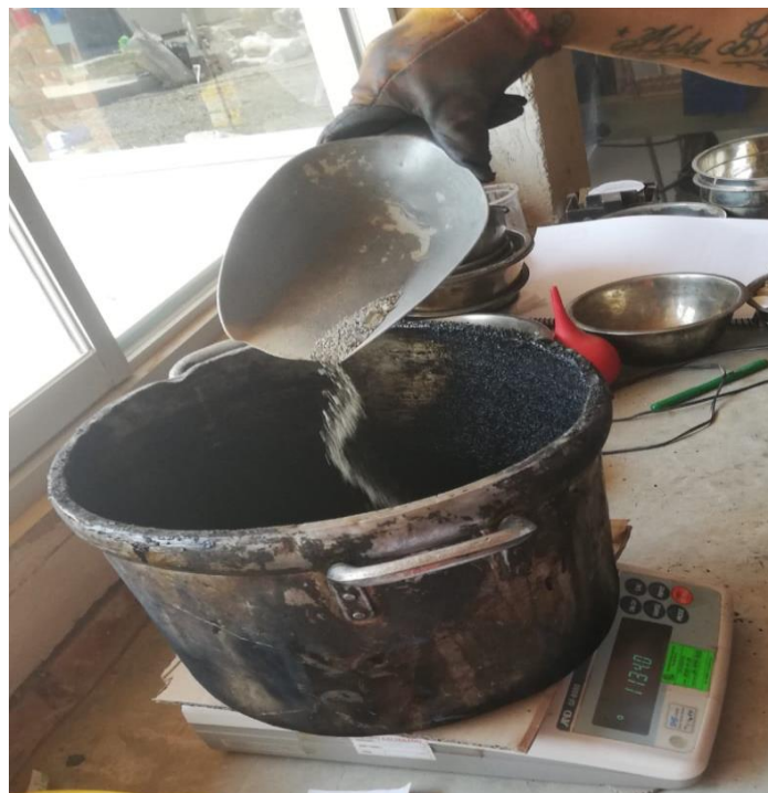
Figura 43: Vertimiento de agregado fino para la elaboración de mezcla asfáltica en caliente.
