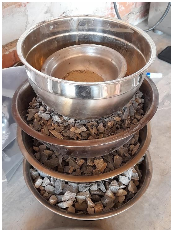
Figura 17: Material separado por retenido en tamizado por mallas.
