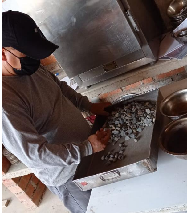
Figura 28: Separación de agregado grueso para elaboración de ensayo “Porcentaje de partículas chatas y alargadas en los agregados”.
