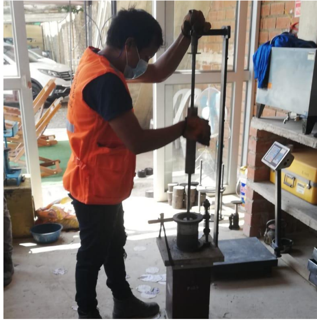
Figura 48: Golpes normativos a las briquetas.
