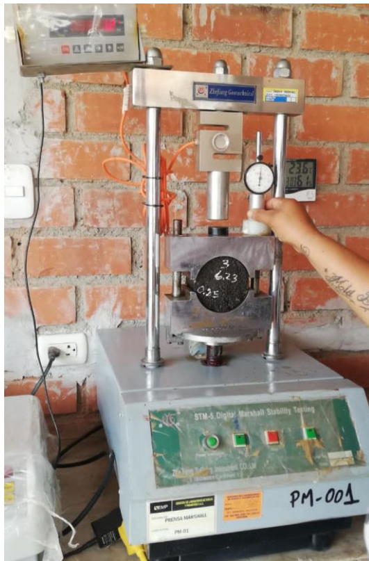
Figura 56: Realización de ensayo Marshall.
