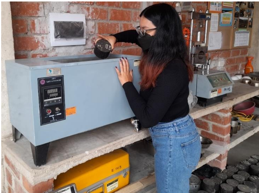
Figura 53: Extracción de muestras para ensayo RICE.
