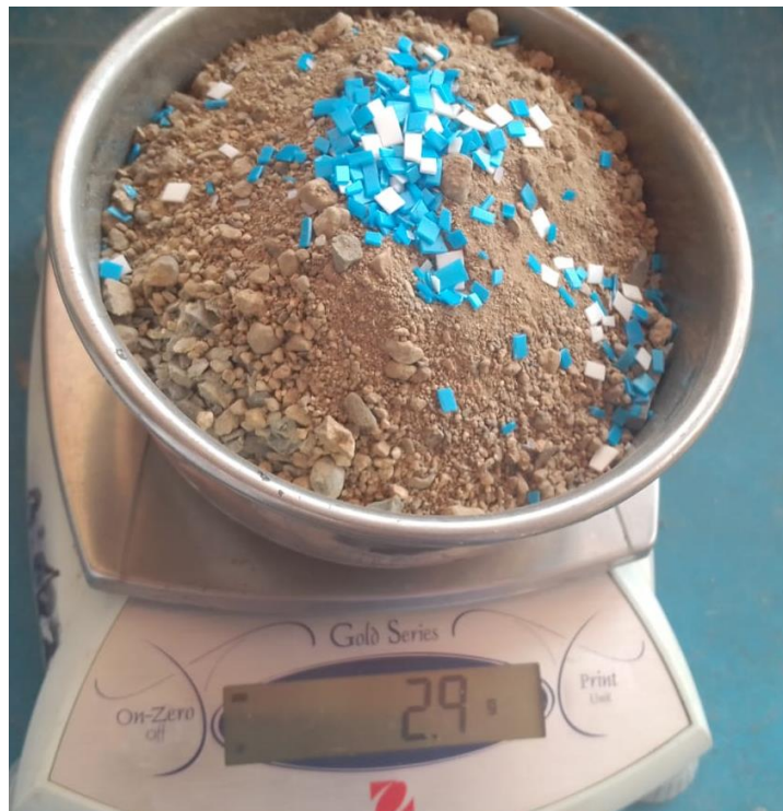
Figura 21: Tarado de agregado mezclado con PEAD.
