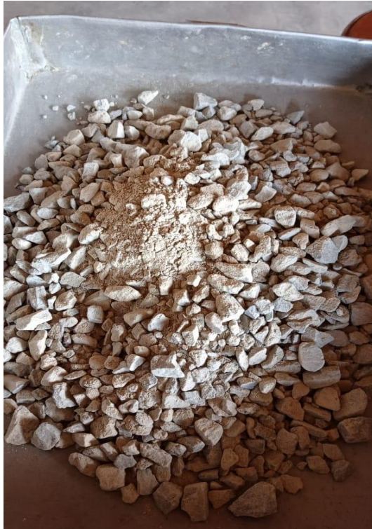
Figura 25: Agregado preparado para ensayo de abrasión (máquina de los ángeles).
