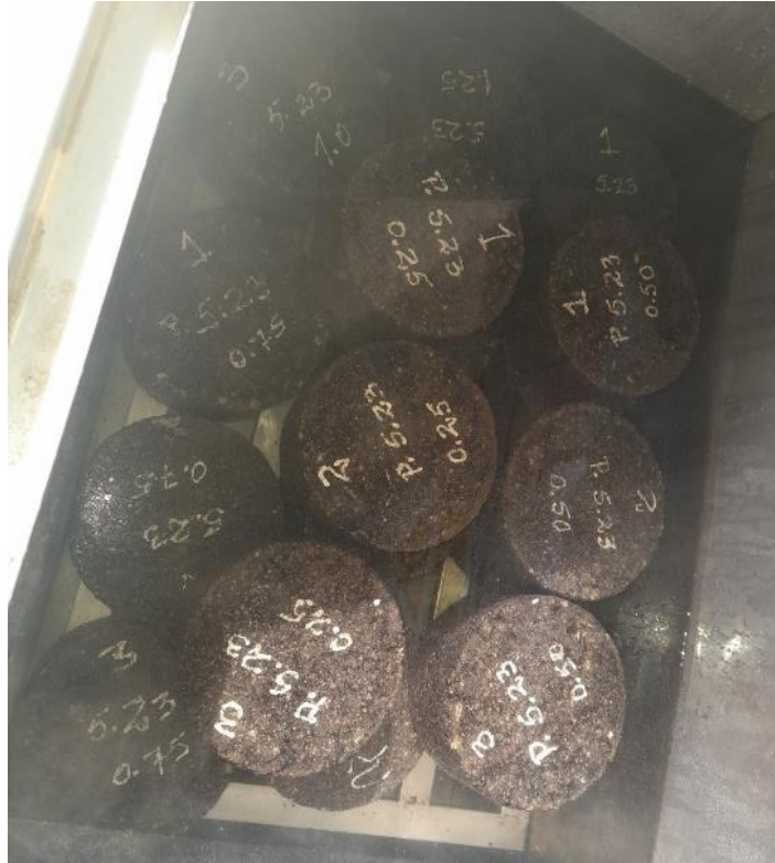
Figura 50: Colocación de briquetas en baño María para ensayo RICE.
