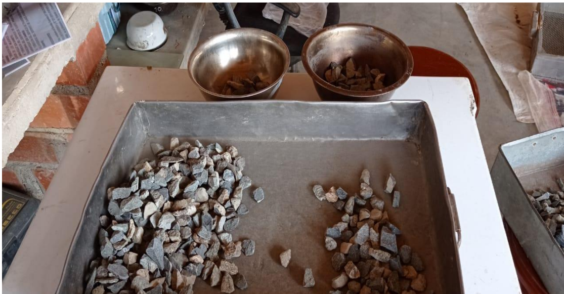
Figura 29: Separación de agregado grueso para elaboración de ensayo “Porcentaje de partículas chatas y alargadas en los agregados”.
