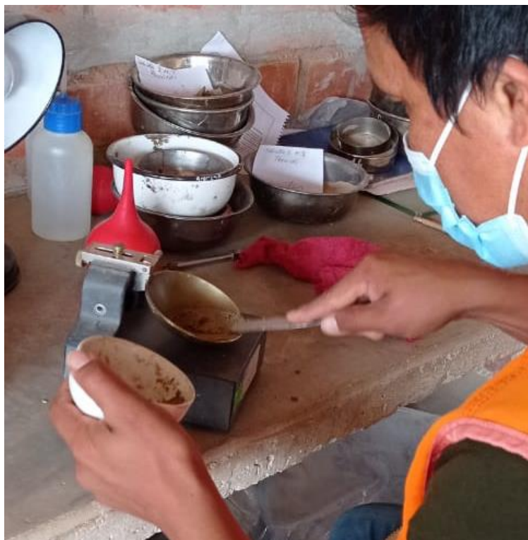
Figura 37: Elaboración de ensayo sobre límites de consistencia material pasante de la malla N°40 y N°200 (Copa Casagrande).
