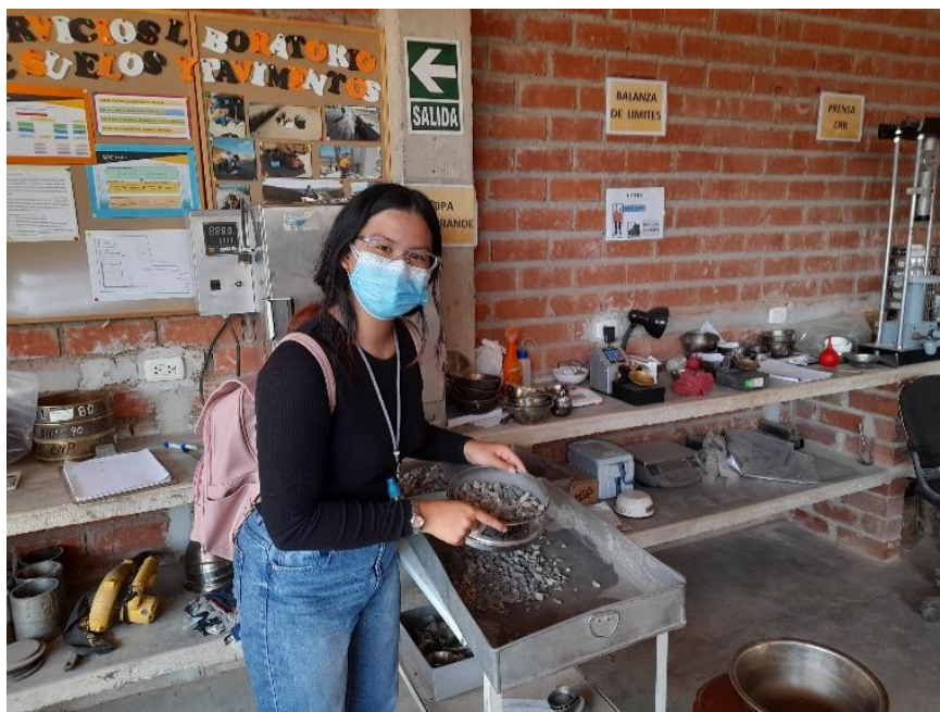
Figura 11: Tamizado de agregado grueso por malla.
