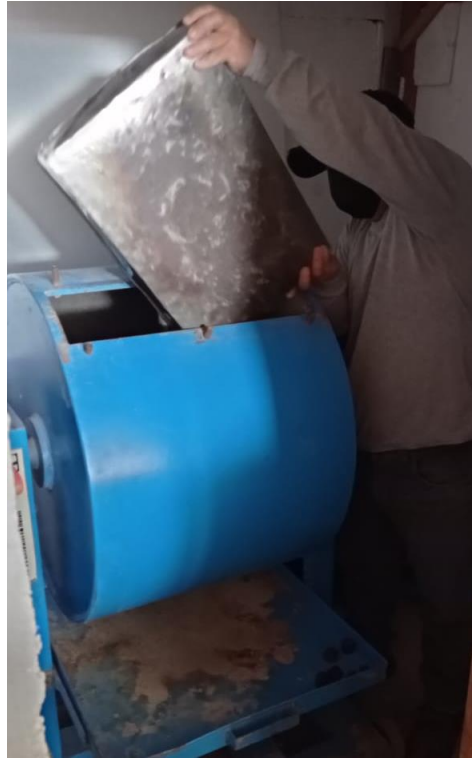
Figura 26: Ejecución de ensayo de abrasión (máquina de los ángeles).
