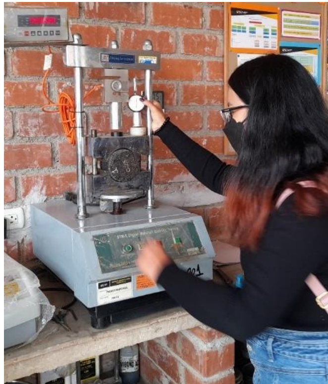
Figura 54: Realización de ensayo Marshall.
