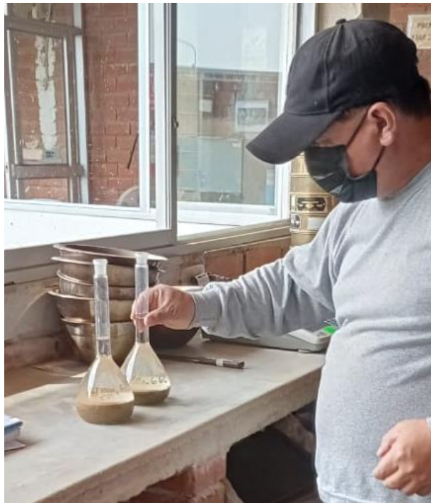
Figura 33: Elaboración de ensayo sobre contenido de sales solubles en el suelo.
