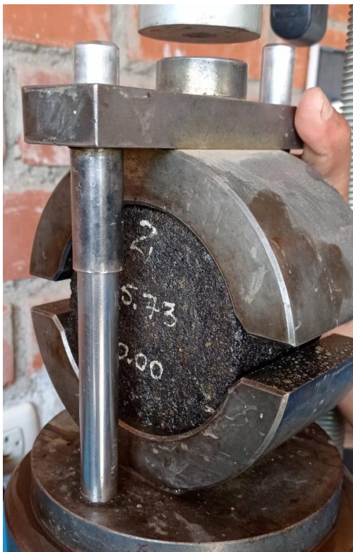
Figura 58: Colocación de briqueta en ensayo Marshall.
