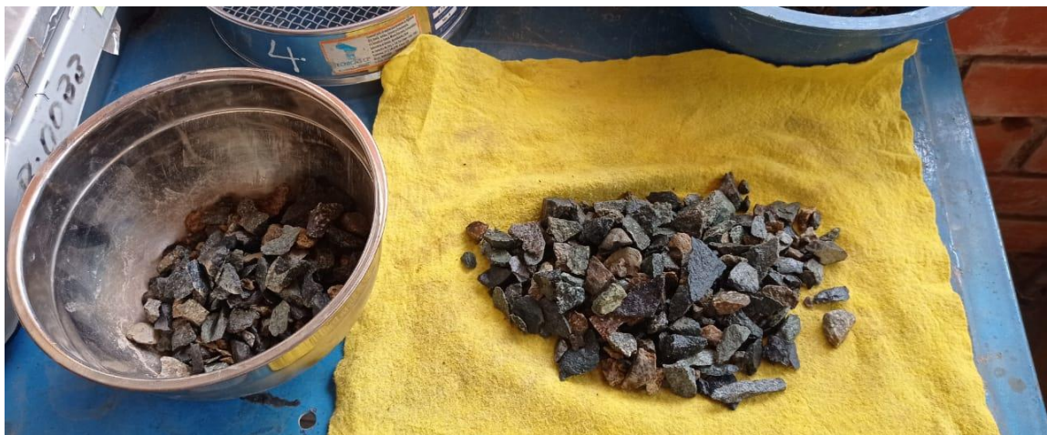
Figura 31: Elaboración de ensayo sobre el peso específico y absorción de los agregados gruesos.
