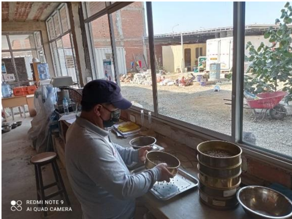
Figura 35: Elaboración de ensayo de granulometría.
