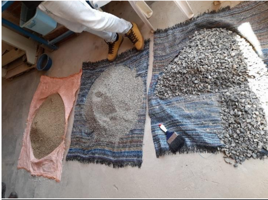
Figura 10: Selección y cuarteo de agregado grueso y fino.
