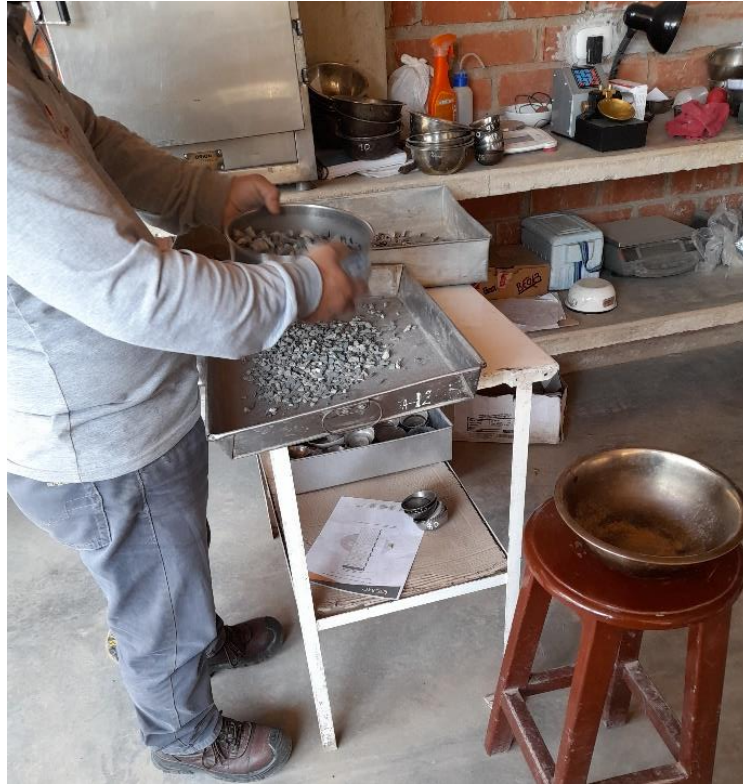
Figura 16: Tamizado de agregado grueso.
