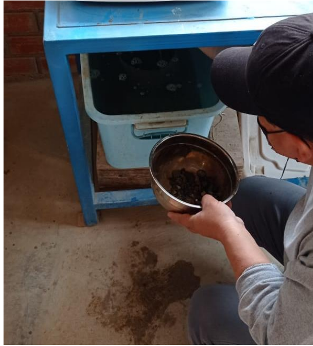
Figura 30: Elaboración de ensayo sobre el peso específico y absorción de los agregados gruesos.
