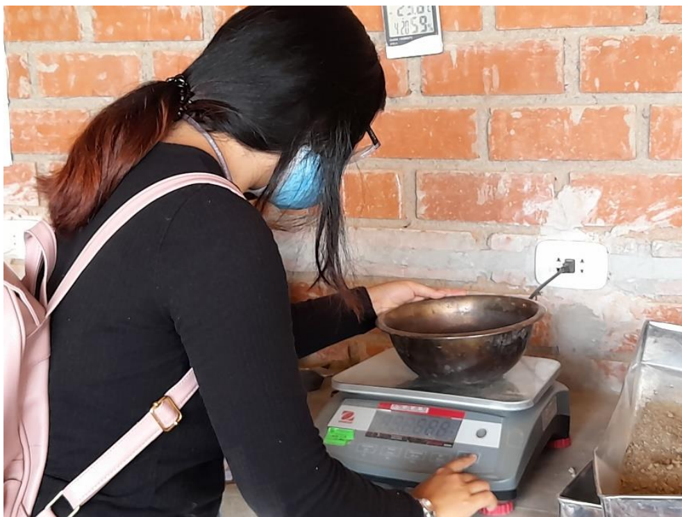
Figura 18: Tarado de material retenido en malla N° 4.
