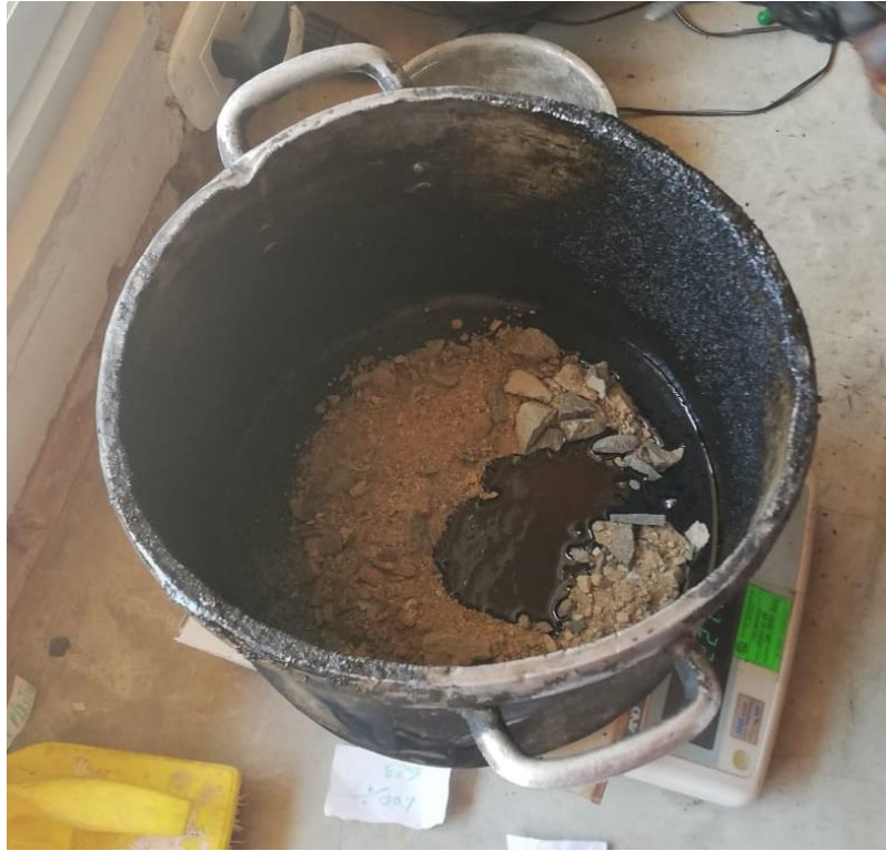
Figura 44: Elaboración de mezcla asfáltica en caliente.
