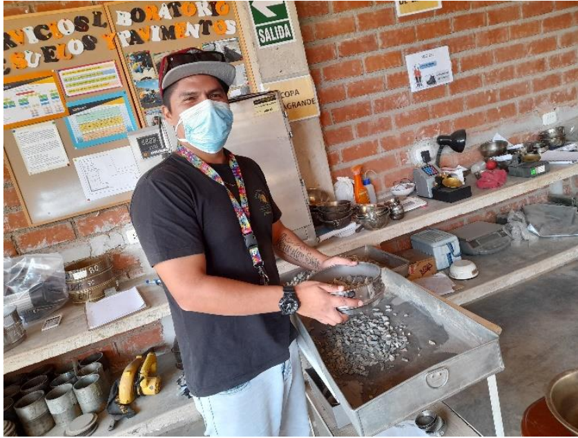
Figura 12: Tamizado de agregado grueso por malla.
