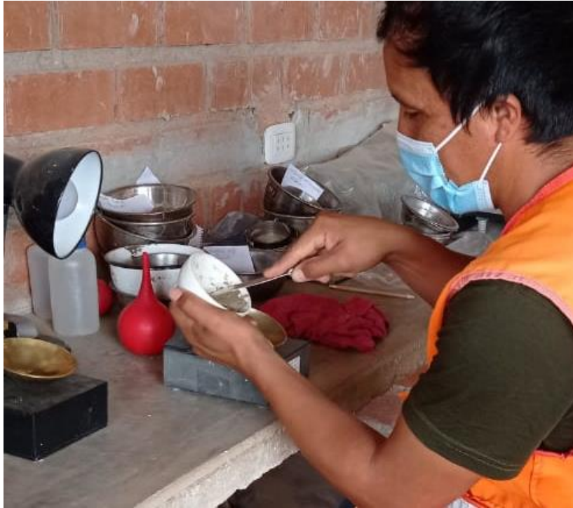
Figura 36: Elaboración de ensayo sobre límites de consistencia material pasante de la malla N°40 y N°200 (Copa Casagrande).
