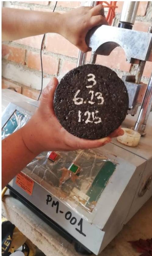
Figura 57: Briqueta ensayada en ensayo Marshall.
