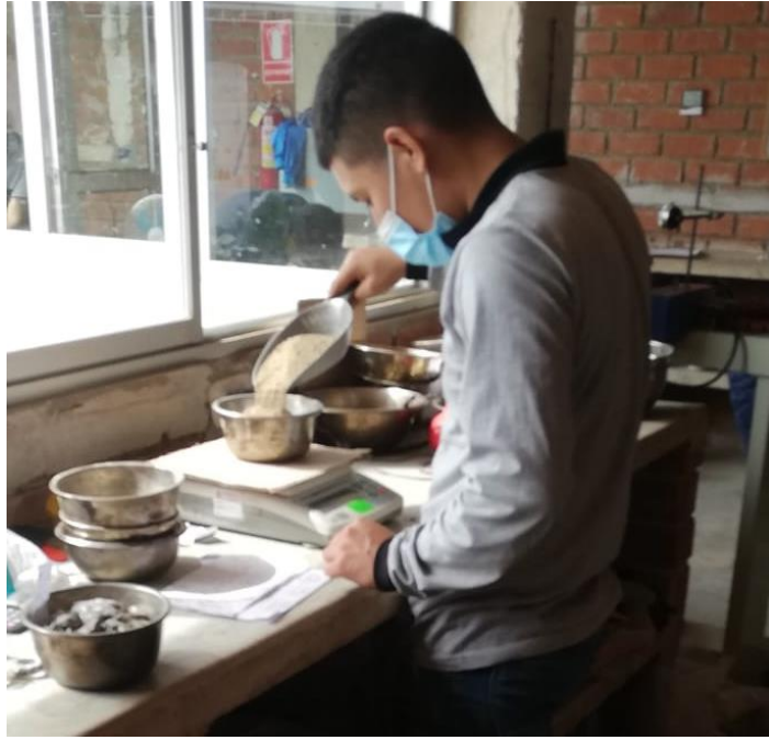
Figura 46: Tarado de materiales para la mezcla asfáltica.
