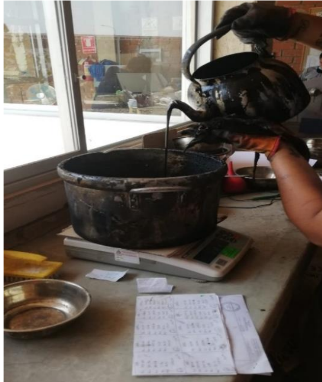
Figura 42: Vertimiento de concreto asfáltico para la elaboración de mezcla asfáltica en caliente.
