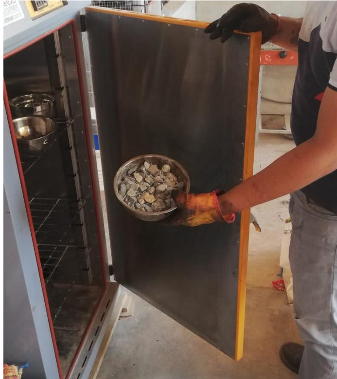
Figura 38: Elaboración de ensayo sobre índice de durabilidad del agregado grueso.
