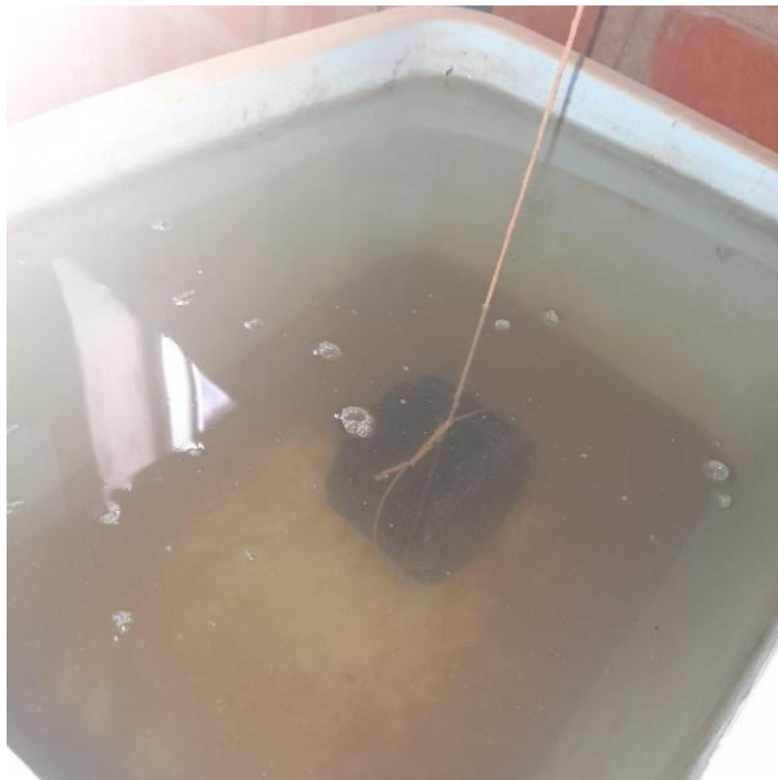
Figura 51: Pesado de briqueta para ensayo RICE.
