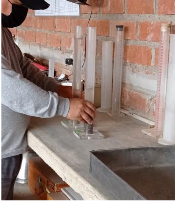
Figura 32: Elaboración de ensayo sobre el equivalente de arena.
