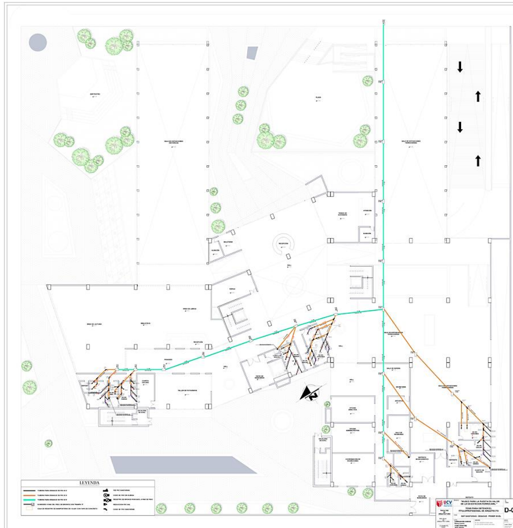
Figura 115: Desagüé – Primer Nivel
