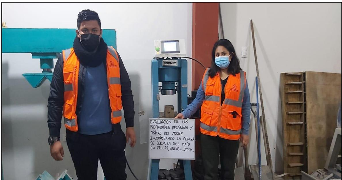
*Ensayo de resistencia a la compresión de los adobes*
