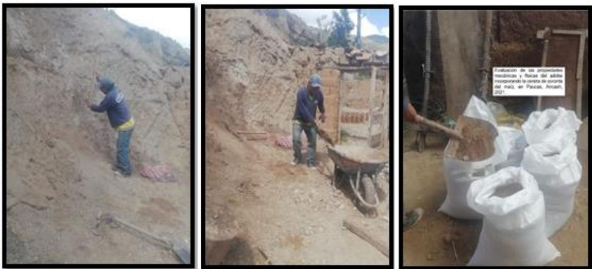
**Figura 3.** Extracción de la muestra de tierra.
