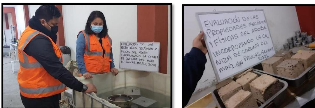
**Figura 11.** Ensayo de absorción de agua del adobe.
