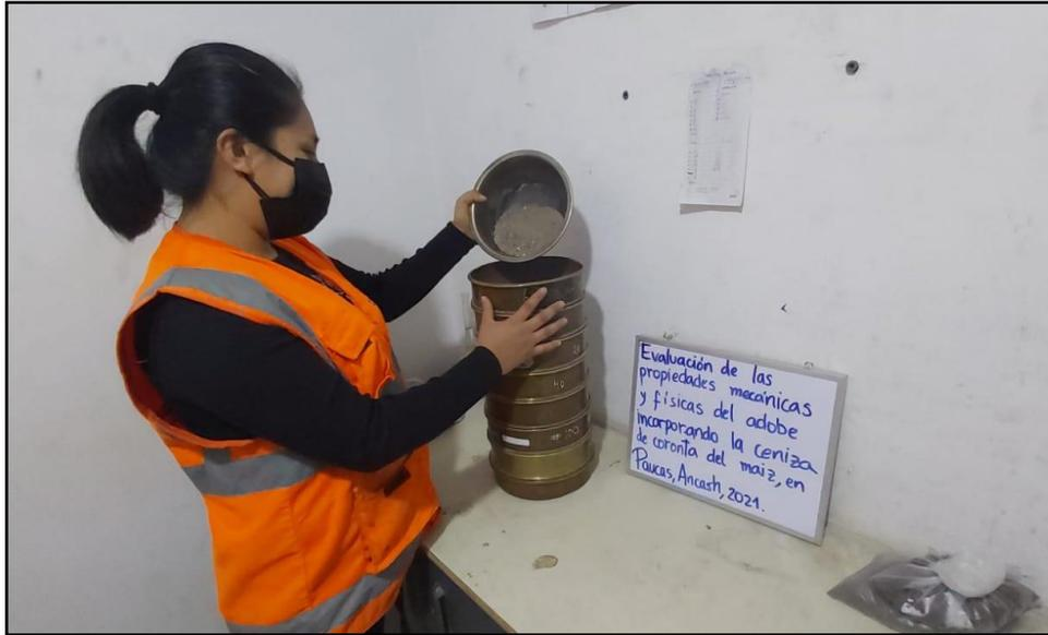
*Tamizado de la muestra para el análisis granulométrico*
