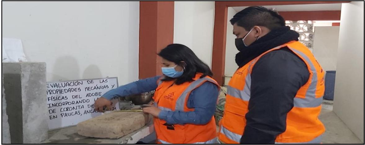
*Medición de las dimensiones del bloque de adobe para el ensayo a la flexión*
