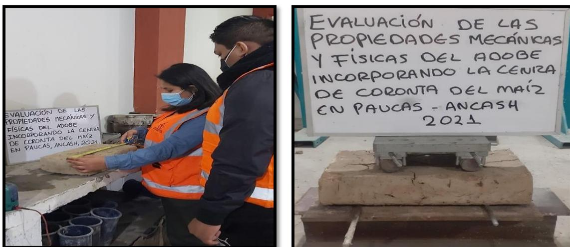
**Figura 9.** Ensayo de resistencia a la flexión del adobe.
