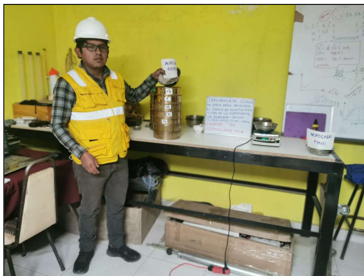
Figura 10. Ensayo granulométrico de la muestra de suelo Fuente. Elaboracion propia
