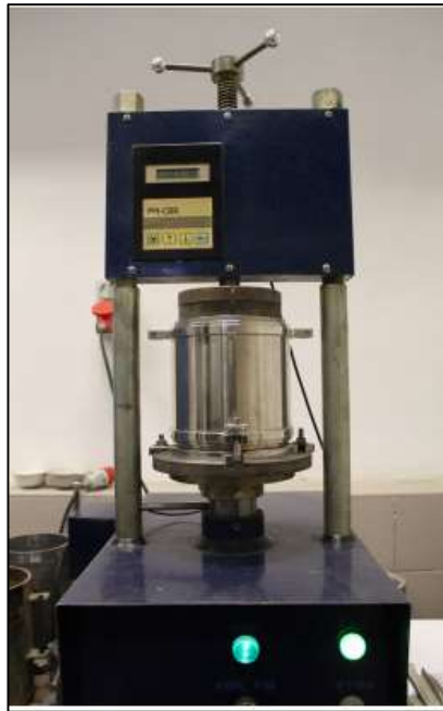
Figura 4. Equipo de Californian Bearing Ratio, tomado de «Dynamic CBR Test to Assess the Soil Compaction» por (Zabielska-Adamska y Sulewska, 2015, p. 1031)
