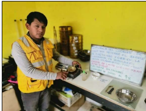
Figura 11. Obtención del límite líquido de la muestra de suelo
