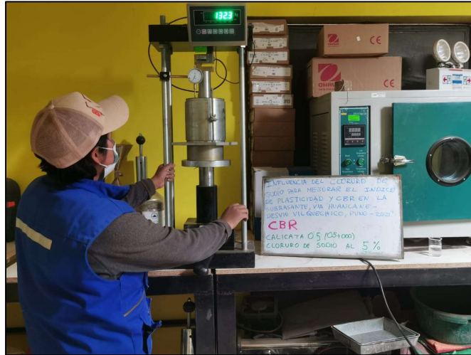
Figura 16. Aplicación de la carga en la prensa CBR
