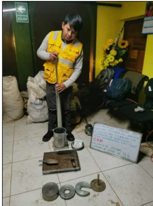
Figura 15. Compactación en el molde CBR
