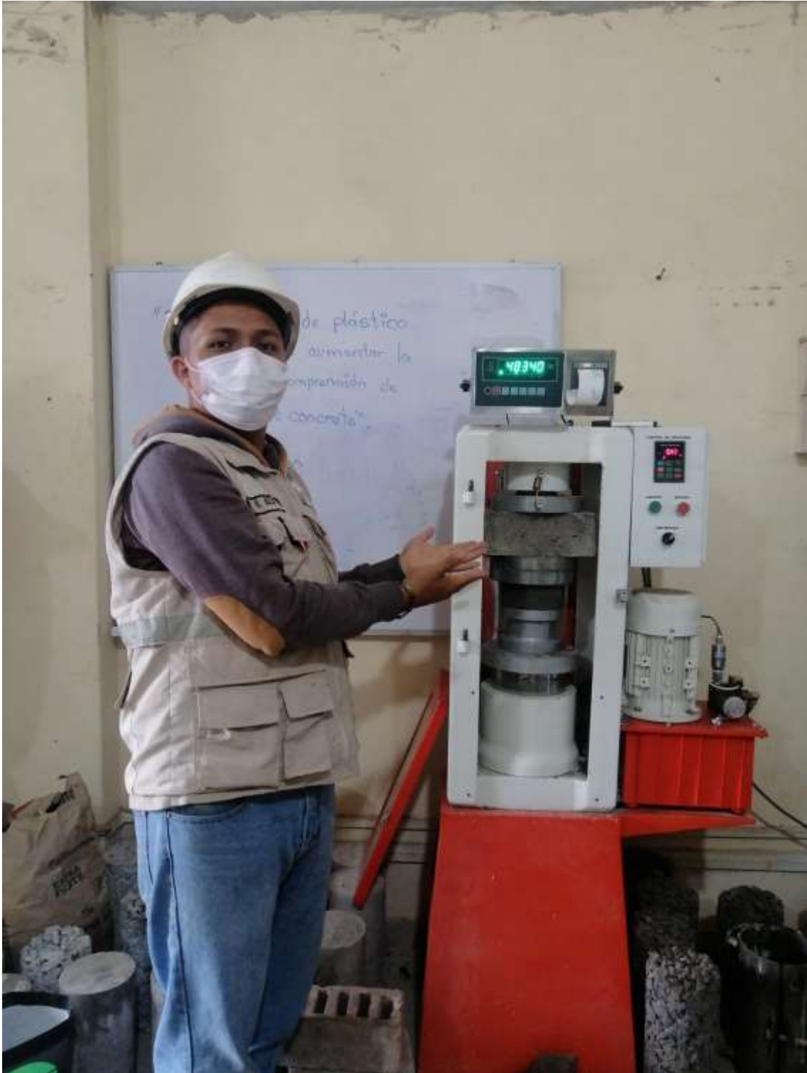
PRUEBA DE RESISTENCIA A LA COMPRESION A LOS 28 DIAS.
