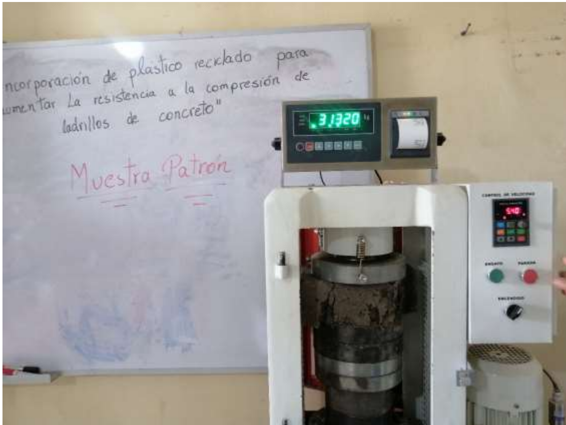
PRUEBA DE RESISTENCIA A LA COMPRESION A LOS 07 DIAS.
