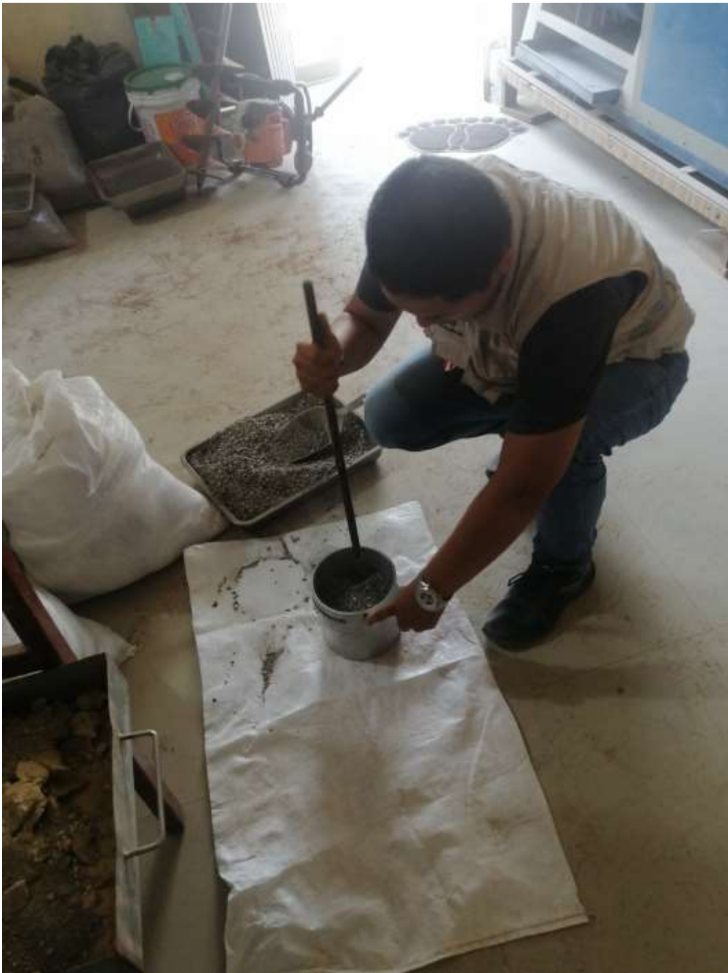
REALIZANDO EL PESO UNITARIO COMPACTADO
