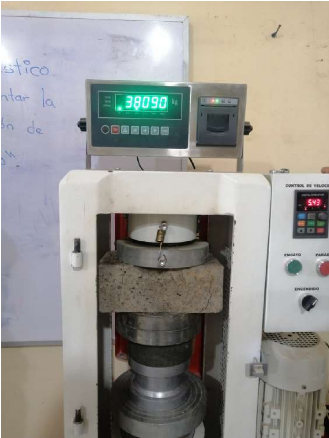
PRUEBA DE RESISTENCIA A LA COMPRESION A LOS 14 DIAS.
