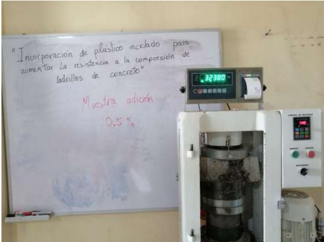
PRUEBA DE RESISTENCIA A LA COMPRESION A LOS 07 DIAS.
