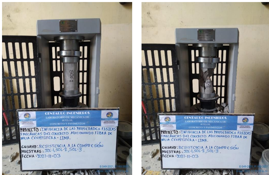
Figura 12: Resistencia a la compresión
