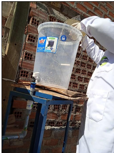
Figura 11: Adaptación del balde de 20 L con aguas residuales
