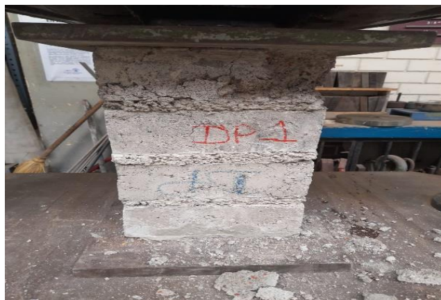
Figura N°19: Ensayo a compresión de pilas patrón
