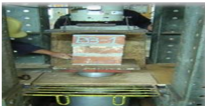
Figura N°08. Ensayo a compresión en pilas
