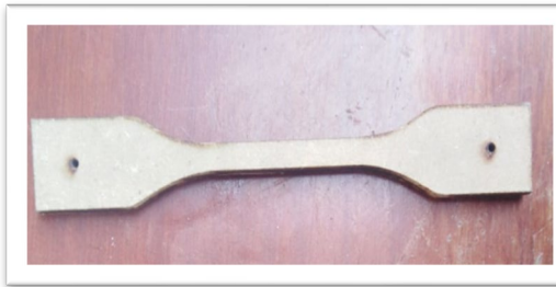
01: MOLDE DE CORTE ASTM D6693.
