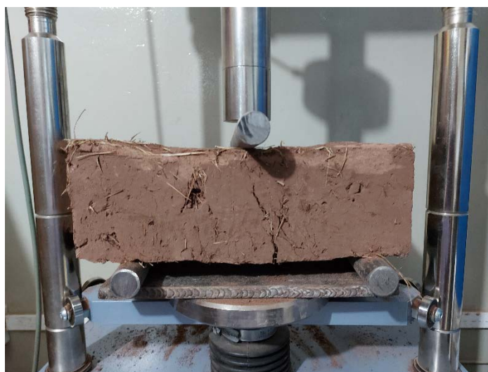
Figura 26 Ensayo de flexión en la muestra de adobe (30x15x10 cm) Fuente: Elaboración propia
