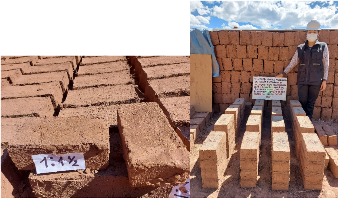
Figura 28 Dosificación del mortero, en donde no presenta fisuras Fuente: Elaboración propia
