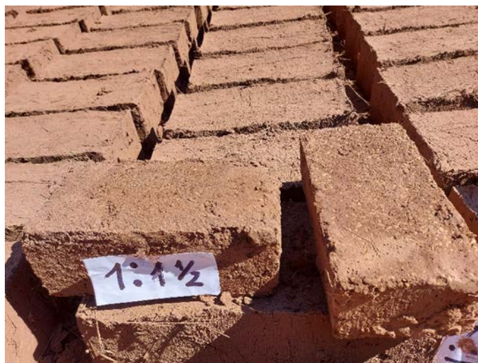
Figura 38 Dosificación del mortero, en donde no presenta fisuras Fuente: Elaboración propia
