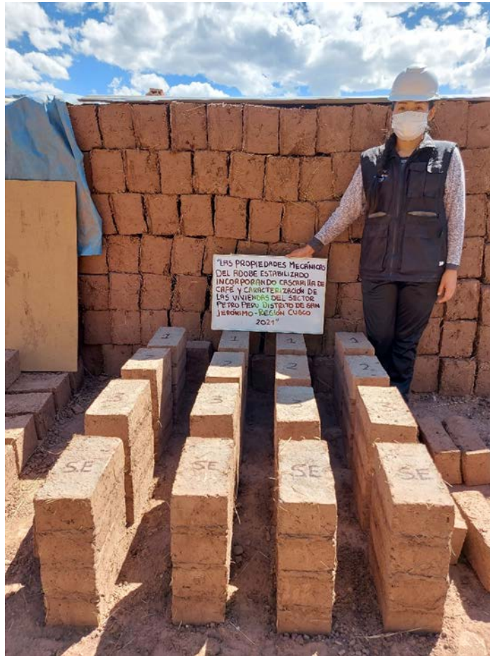
Figura 39 Se procedió a realizar los muretes con la dosificación del mortero óptima de suelo-arena en 1:1 ½ para el porcentaje de dosificación de la cascarilla de café
