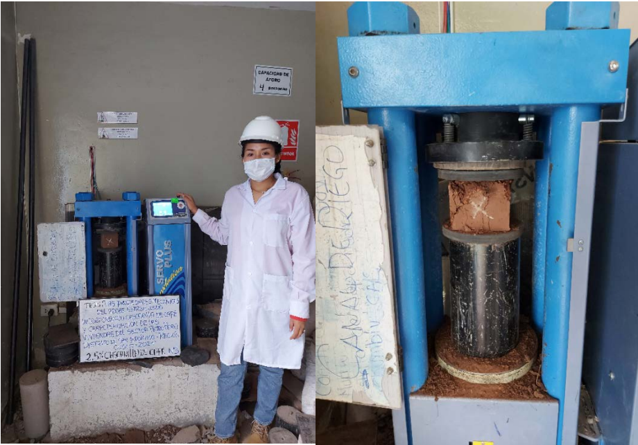
Figura 22 Ensayos a la Resistencia a la compresión por unidad individual - 2.50% de cascarilla de café Fuente: Elaboración propia
