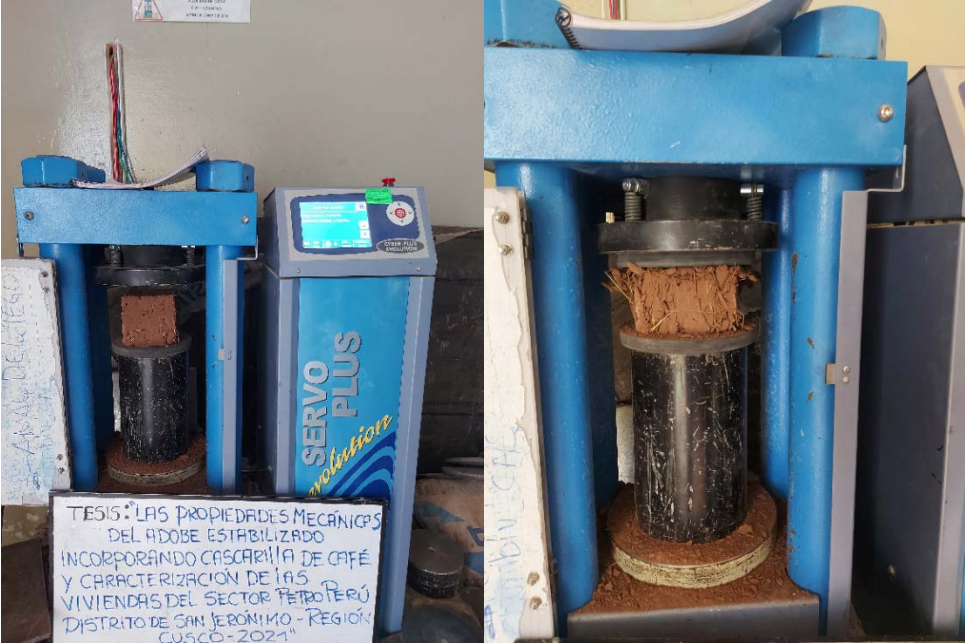
Figura 21 Ensayos a la Resistencia a la compresión por unidad individual - Adobe Patrón Fuente: Elaboración propia
