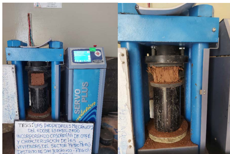
Figura 32 Ensayos a la Resistencia a la compresión por unidad individual - Adobe Patrón
