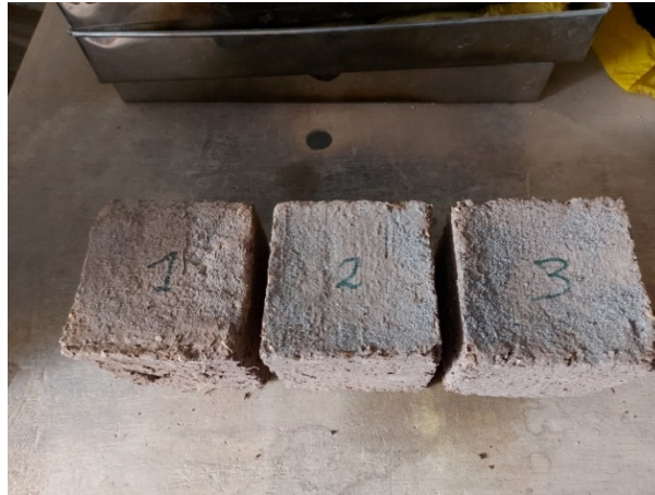
Figura 17 Muestra a los ensayos a la compresión 10x10x10 cm Fuente: Elaboración propia
