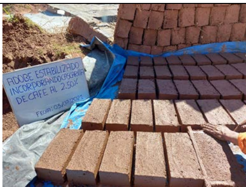
Paso N° 14: Unidades de adobe estabilizado incorporando cascarilla de café al 2.50%
