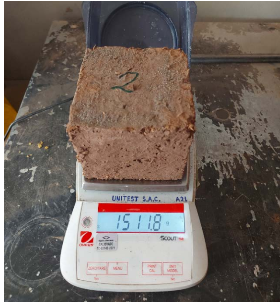
Figura 19 Peso de la muestra de adobe con 4.50% de cascarilla de café (10x10x10cm)
