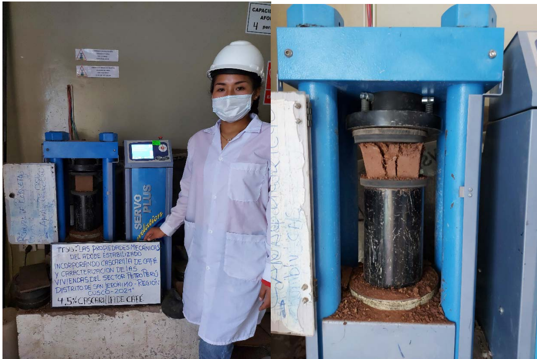
Figura 23 Ensayos a la Resistencia a la compresión por unidad individual - 4.50% de cascarilla de café Fuente: Elaboración propia
