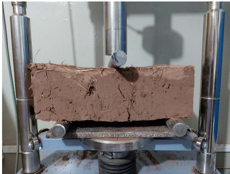
Figura 34 Ensayo de flexión en la muestra de adobe (30x15x10 cm)
