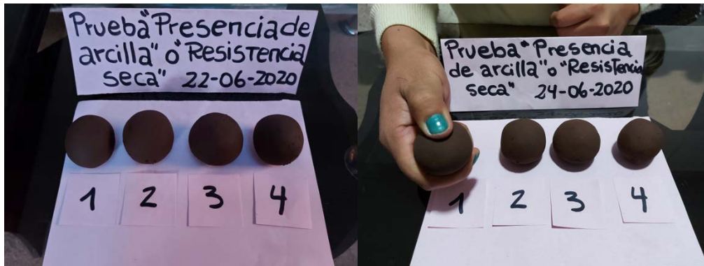
Figura 5 Prueba de presencia de arcilla o resistencia seca Fuente: Elaboración propia
