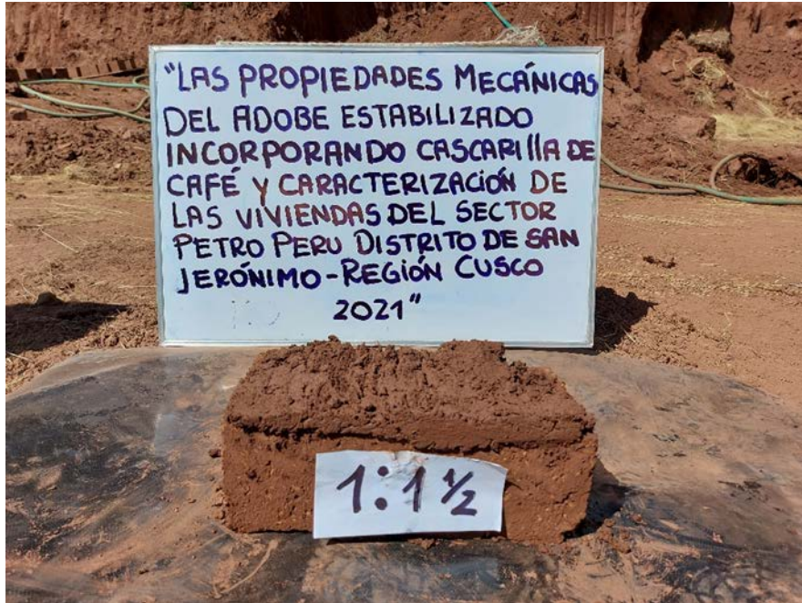
Figura 37 Dosificación suelo – arena gruesa Fuente: Elaboración propia
