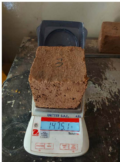
Figura 18 Peso de la muestra de adobe con 6.50% de cascarilla de café (10x10x10cm) Fuente: Elaboración propia
