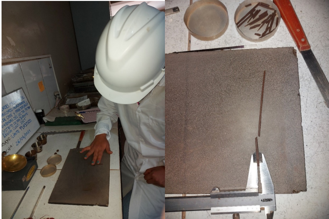
Figura 16 Límite plástico Fuente: Elaboración propia
