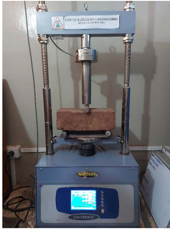
Figura 25 Maquina usada para ensayos de resistencia a la flexión Fuente: Elaboración propia
