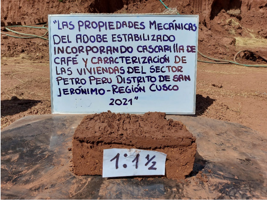
Figura 27 Dosificación Suelo – Arena gruesa Fuente: Elaboración propia
