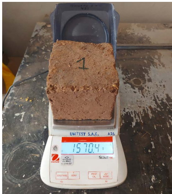
Figura 20 Peso de la muestra de adobe con 2.50% de cascarilla de café (10x10x10cm)
