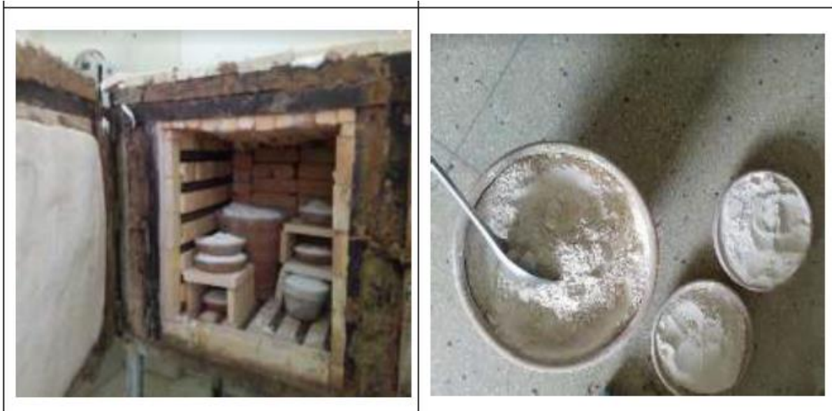
Figura 8: Calcinación de huesos a 750°C y obtención de óxido de calcio
