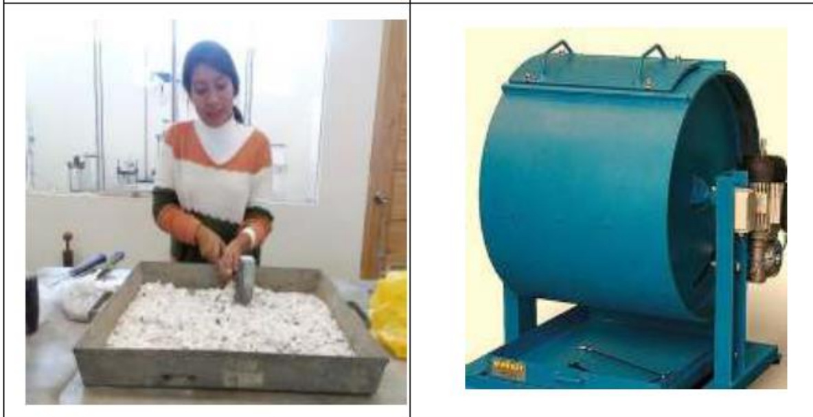
Figura 6: Triturado manual y molienda en máquina los ángeles
