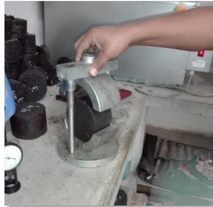
Fotografía 26. Ensayo para hallar el flujo y la estabilidad.
