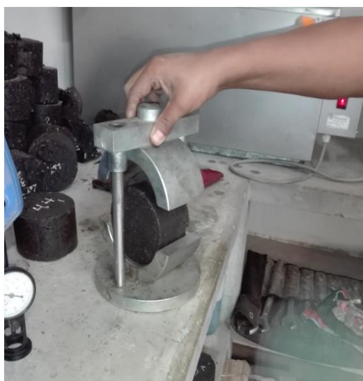
Figura 23. Ensayo para hallar el flujo y la estabilidad.
