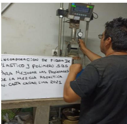
Fotografía 29. Ensayo para hallar estabilidad.
