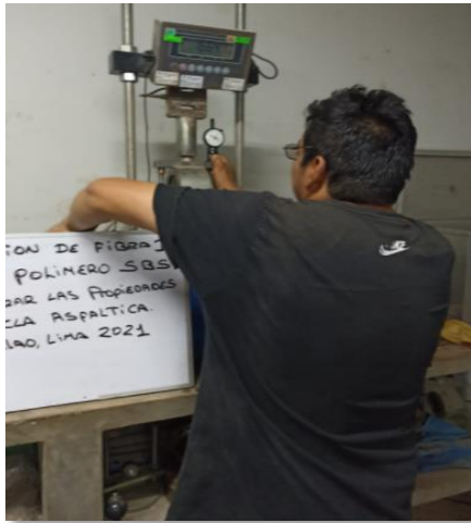
Figura 25. Ensayo para hallar el flujo y la estabilidad.
