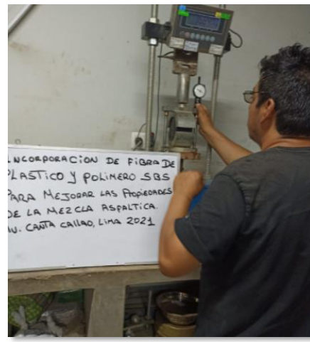
Figura 26. Ensayo para hallar estabilidad.
