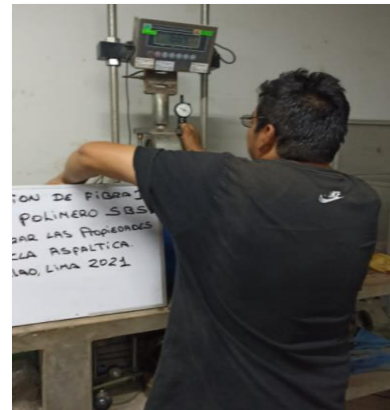
Fotografía 28. Ensayo para hallar el flujo y la estabilidad.
