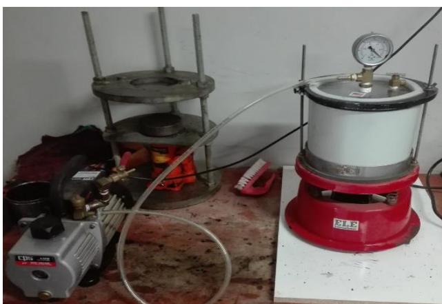
Figura 27. Determinación de gravedad específica y densidad en materiales asfálticos
