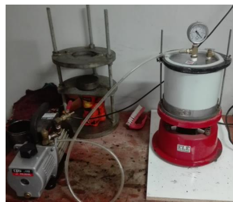
Fotografía 30. Determinación de gravedad específica y densidad en materiales asfálticos.
