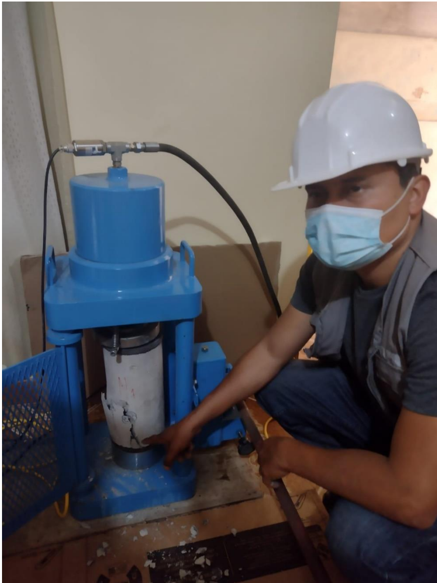
Figura b: Ensayo de resistencia a la compresión
