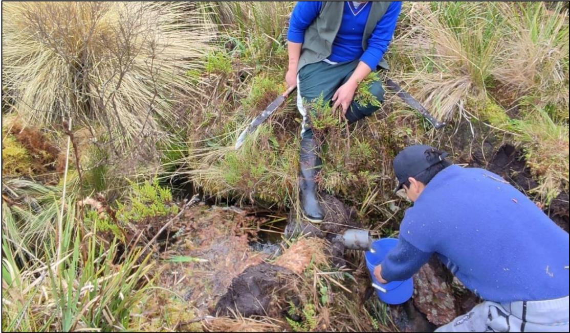
Figura 3. Método del aforo del caudal realizado el 17 de agosto del año 2021 (elaboración propia).
