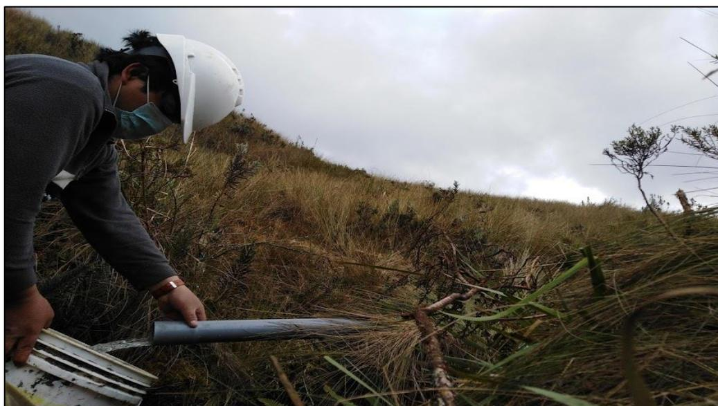
*Figura 6.* Método del aforo del caudal realizado el 29 de setiembre del año 2021 (elaboración propia).
