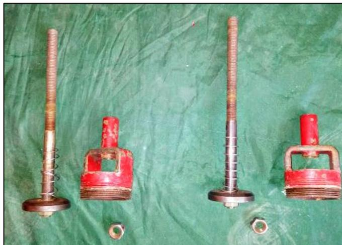
Figura 8. Configuración de la válvula de impulsión de la bomba de ariete para una altura de alimentación de 1 metro (Elaboración propia).
