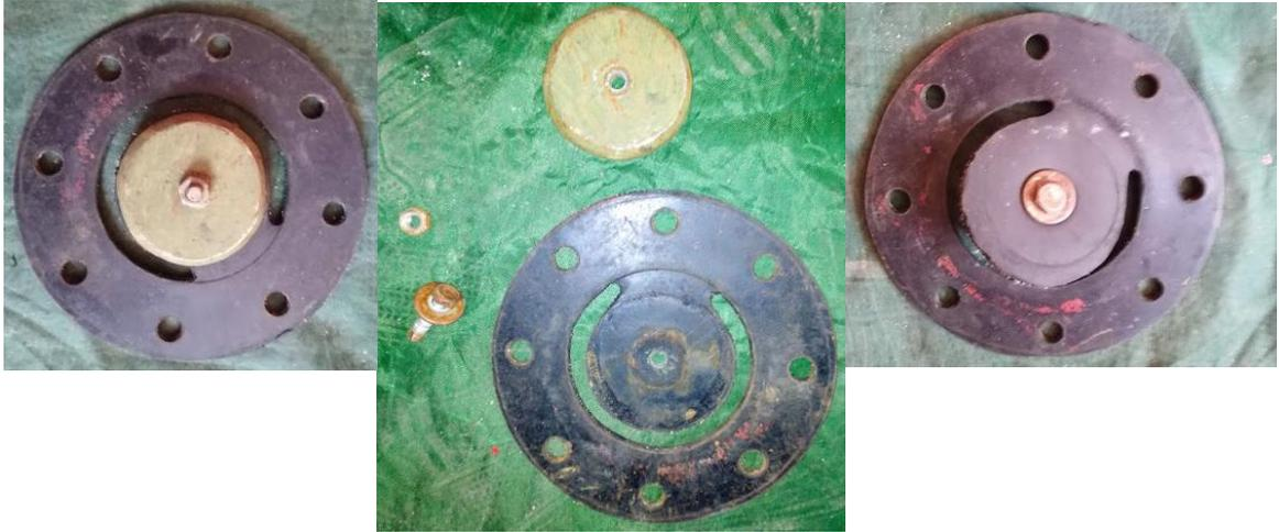
Fotografía 7. Partes de la empaquetadura enlonada.
