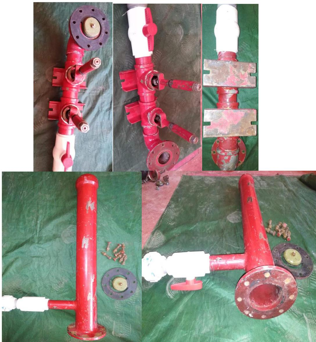
*Fotografía 9. Partes del cuerpo de la bomba de ariete hidráulico.*
