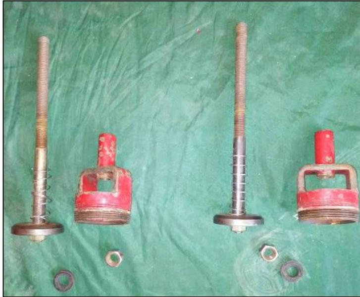
*Figura 9.* Configuración de la válvula de impulsión de la bomba de ariete para una altura de alimentación de 2 metros (elaboración propia).
