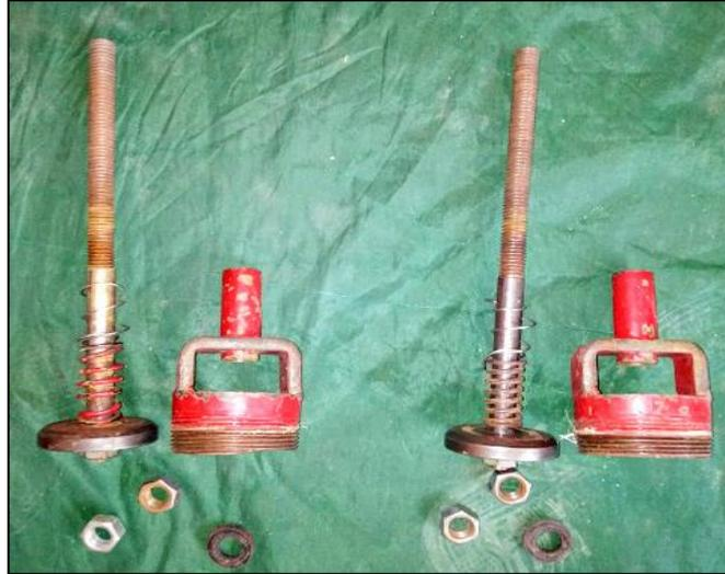
*Figura 10.* Configuración de la válvula de impulsión de la bomba de ariete para una altura de alimentación de 3 metros y 4 metros (elaboración propia).
