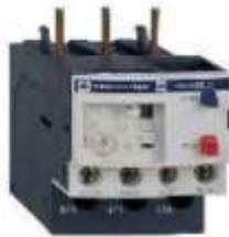
Es un mecanismo que sirve como elemento de protección del motor. Su misión consiste en desconectar el circuito cuando la intensidad consumida por el motor, supera durante un tiempo corto, a la permitida por este, evitando que el bobinado se queme.
