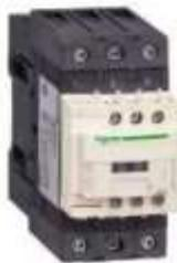
Es un mecanismo cuya misión es la de cerrar unos contactos, para permitir el paso de la corriente a través de ellos. Esto ocurre cuando la bobina del contactor recibe corriente eléctrica, comportándose como electroimán y atrayendo dichos contactos. Partes:
