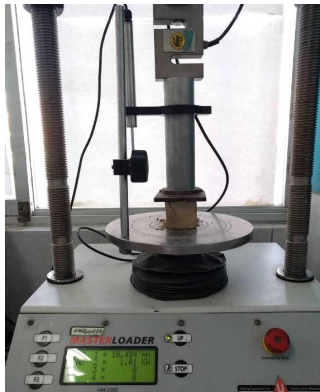
Figura 11. Realizando ensayo de resistencia a la compresión a los cubos de tierra.
