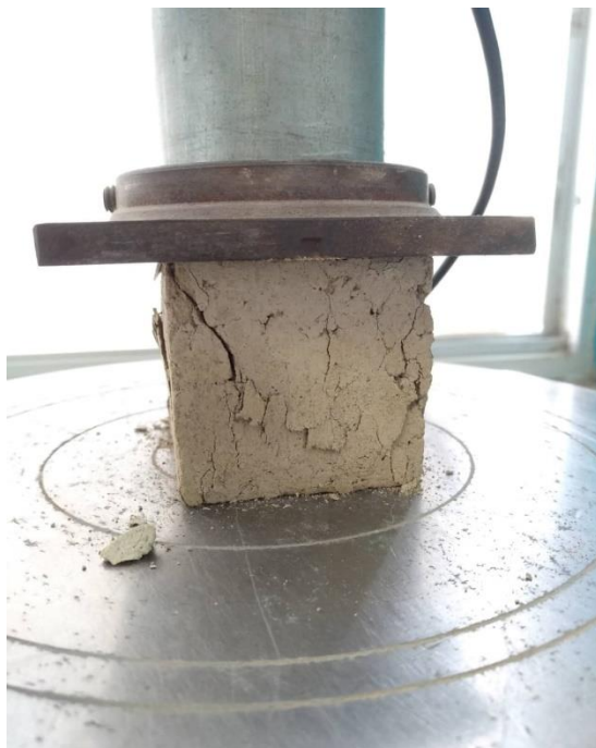
Figura 13. Falla del cubo de tierra al realizar ensayo de compresión.
