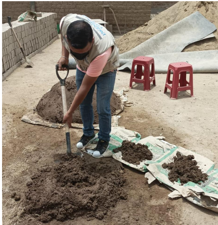
Figura 5. Preparación de mezcla para probeta patrón.
