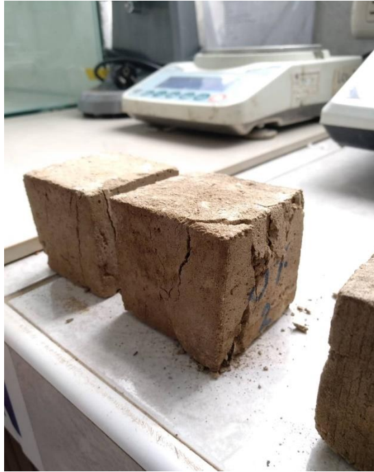
Figura 14. Cubos de tierra después del ensayo de compresión.
