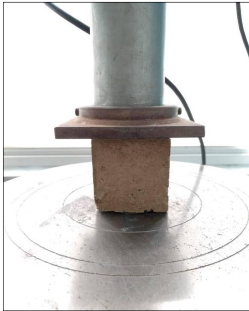
Figura 3. Ensayo de Resistencia a la compresión.
