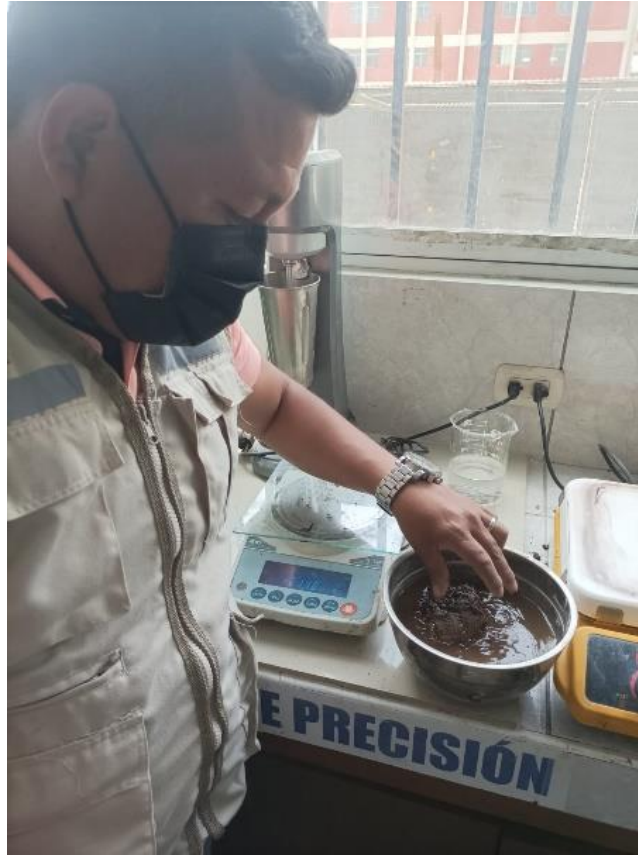
Figura 16. Probeta sumergida, para cálculos de porosidad.
