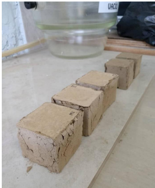
Figura 15. Cubos de tierra después del ensayo de compresión.
