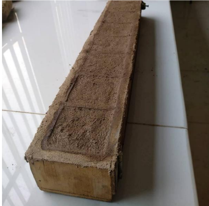
Figura 8. Moldeo de cubos de tierra de (10x10), compactados.
