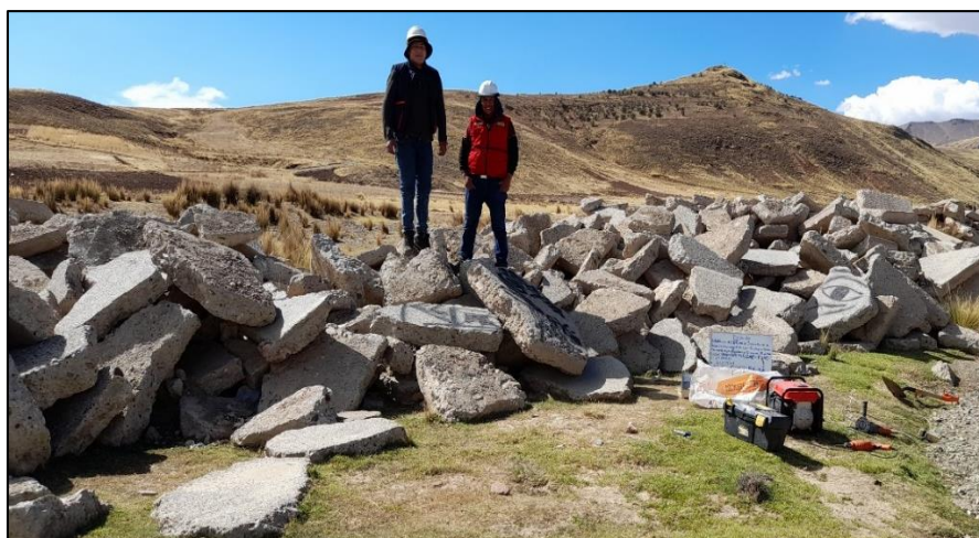
Figura 21. Pavimento rígido reciclado
