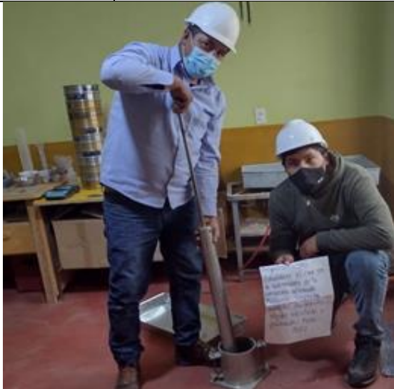
Ensayo de PROCTOR MODIFICADO
