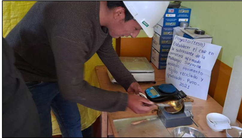
Figura 18. Ensayo de la copa de casa grande Fuente. Elaboración propia
