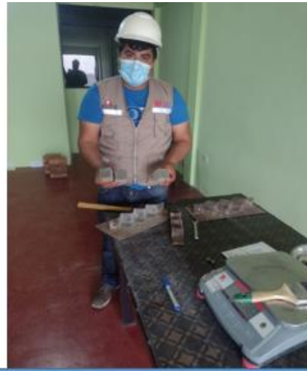
DESENCOFRADO A LAS 24 HORAS DESPUES DEL VACIADO
