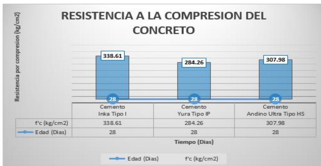
Figura 15. Comparación de la Resistencia a la compresión a los 28 días.
