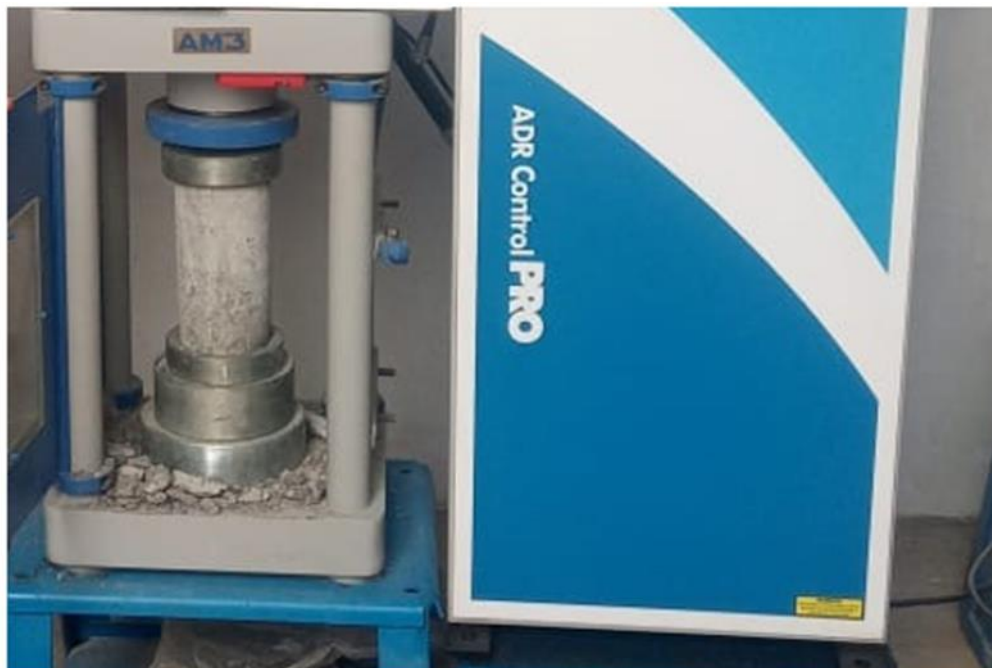
Figura 7. Ensayo a compresión de probetas a los 28 días
