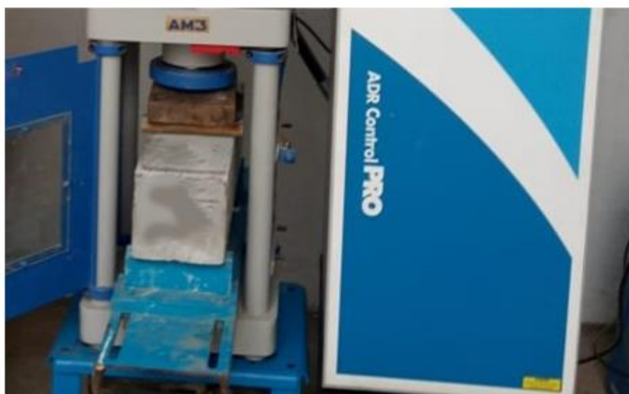
Figura 8. Ensayo por flexión a los 7 días
