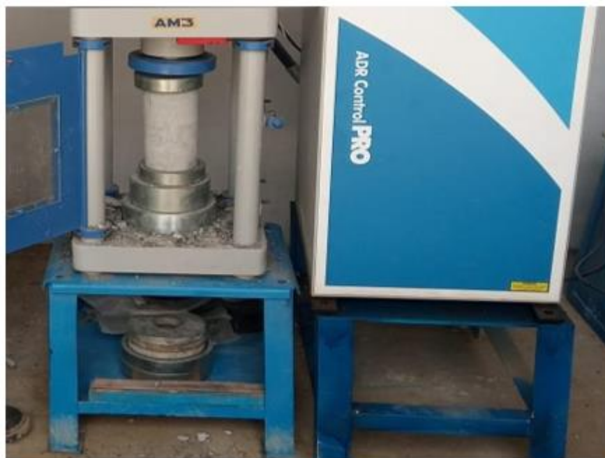
Figura 6. Ensayo de la Resistencia a la Compresión de probetas a los 14 días
