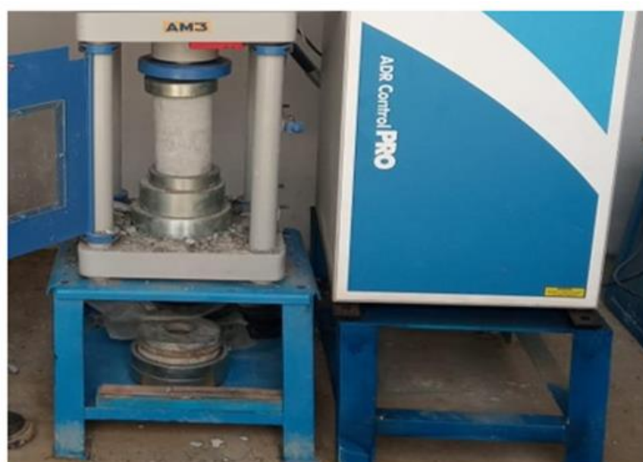
Figura 5. Ensayo a compresión de probetas a los 7 días
