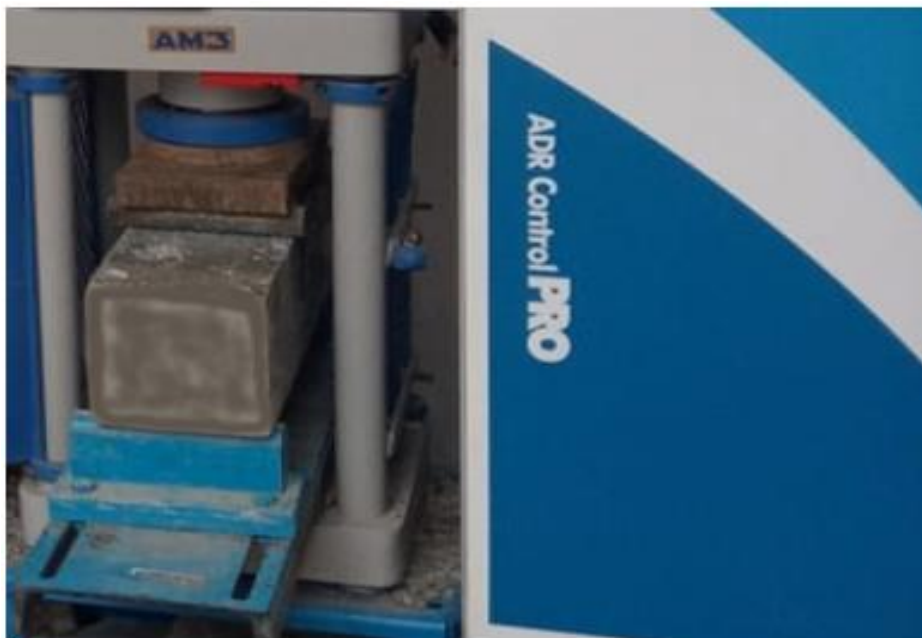
Figura 10. Ensayos por flexión a los 28 días
